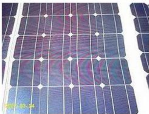
Σχήμα 7.7: Φωτοβολταϊκό από μονοκρυσταλλικό πυρίτιο [29]
