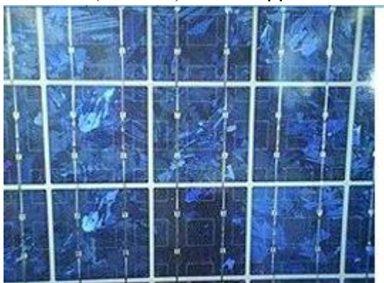
Σχήμα 7.6: Φωτοβολταϊκό από πολυκρυσταλλικό πυρίτιο [29]
