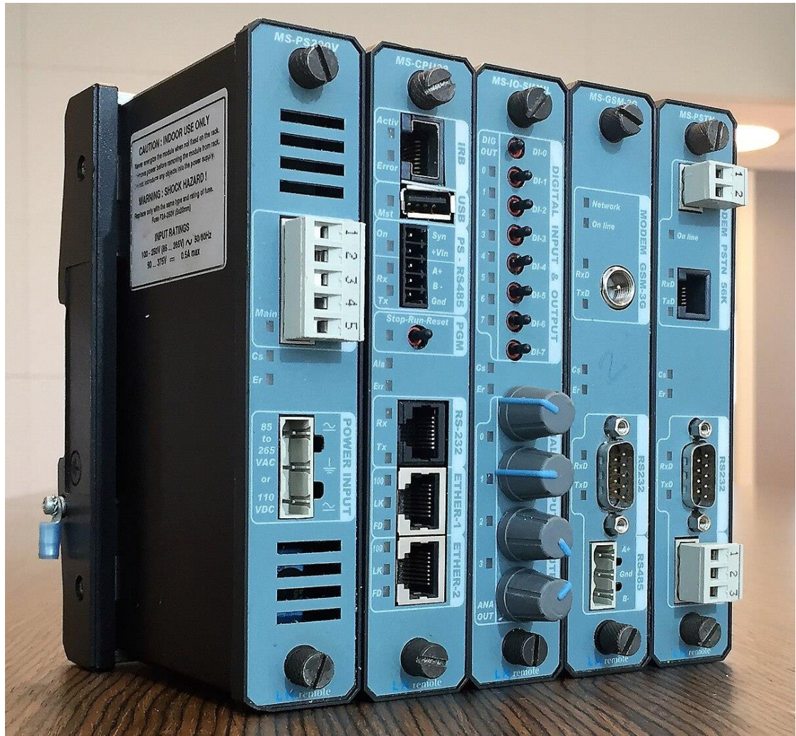
Εικόνα 2.1-iii: Remote Terminal Unit. Πηγή: wikipedia.org 3
