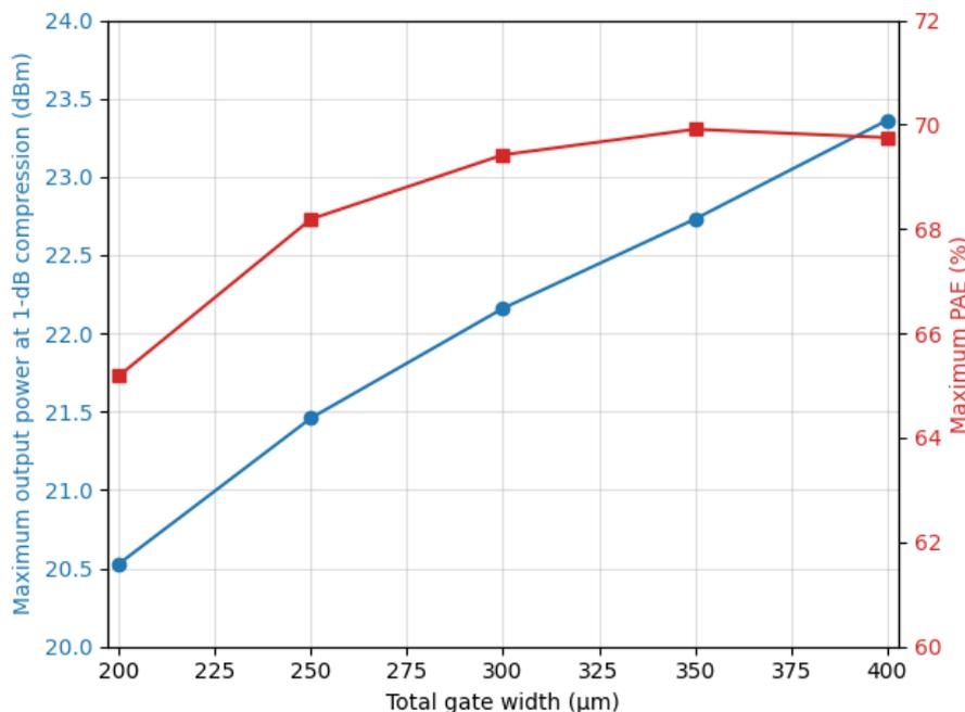
Σχήμα 1.4: Μέγιστη ισχύς εξόδου στο σημείο συμπίεσης 1 dB και μέγιστη απόδοση ισχύος (PAE) σε συνάρτηση με το συνολικό πλάτος πύλης
