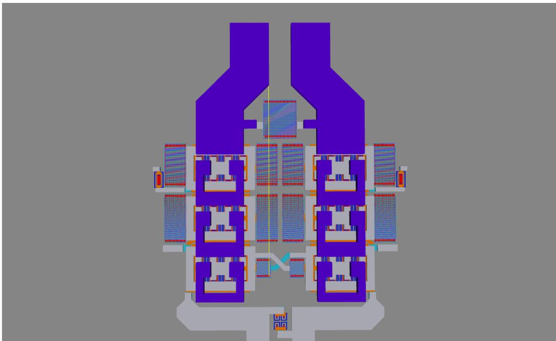
Σχήμα 1.6: Layout του σταδίου ενισχυτή ισχύος
