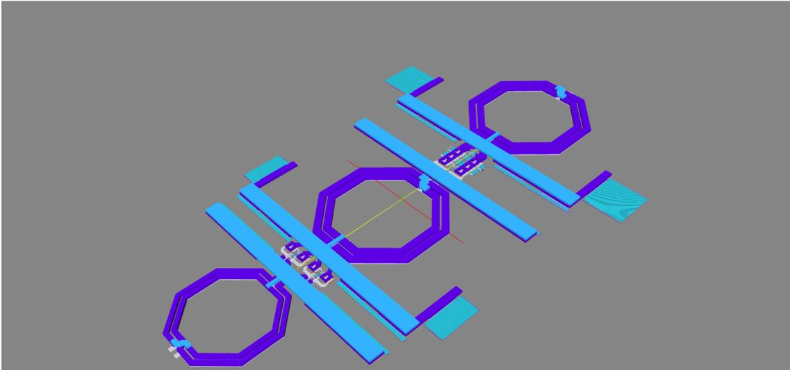
Σχήμα 1.9: Layout δισταδιακού ενισχυτή ισχύος
