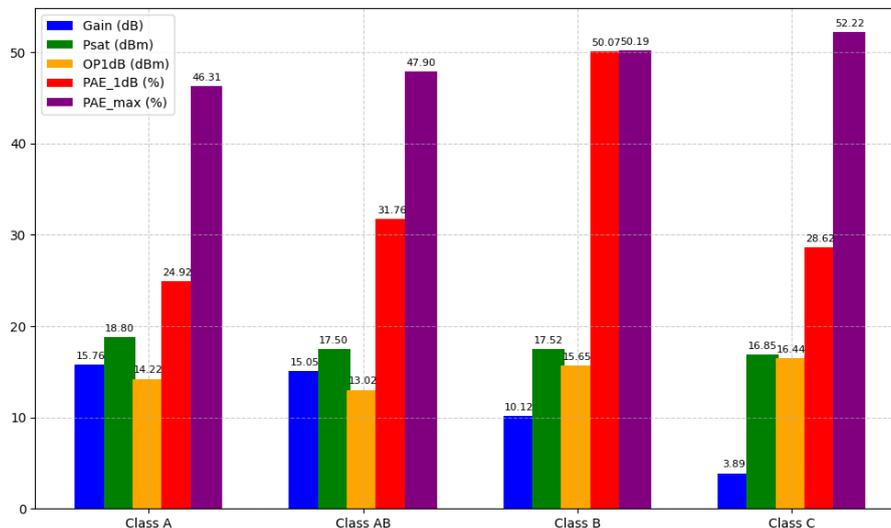
Σχήμα 1.3: Σύγκριση των επιδόσεων του ενισχυτή ισχύος στις τάξεις λειτουργίας A, AB, B και C
