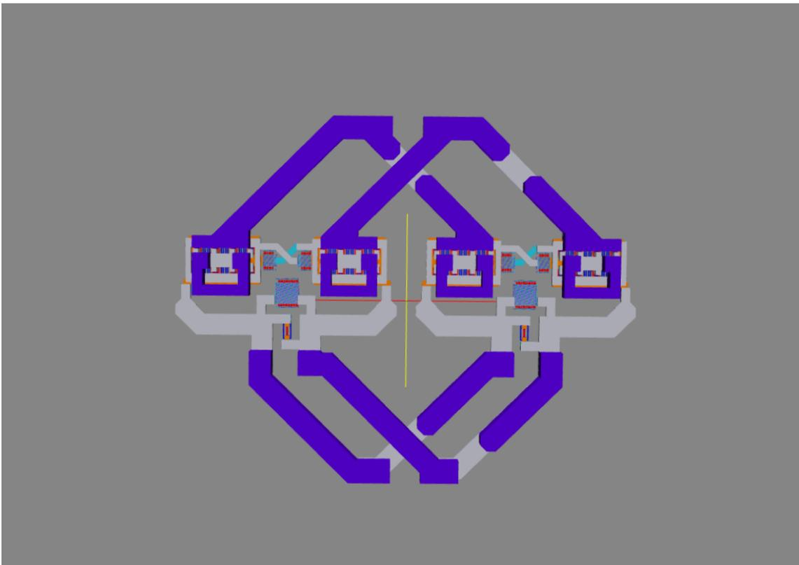
Σχήμα 1.8: Layout του Driver σταδίου
