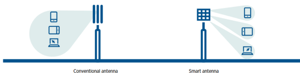
Εικόνα 1.2. Κάλυψη δικτύου μέσω conventional antenna array έναντι σε smart antenna array με χρήση beamforming [1]
