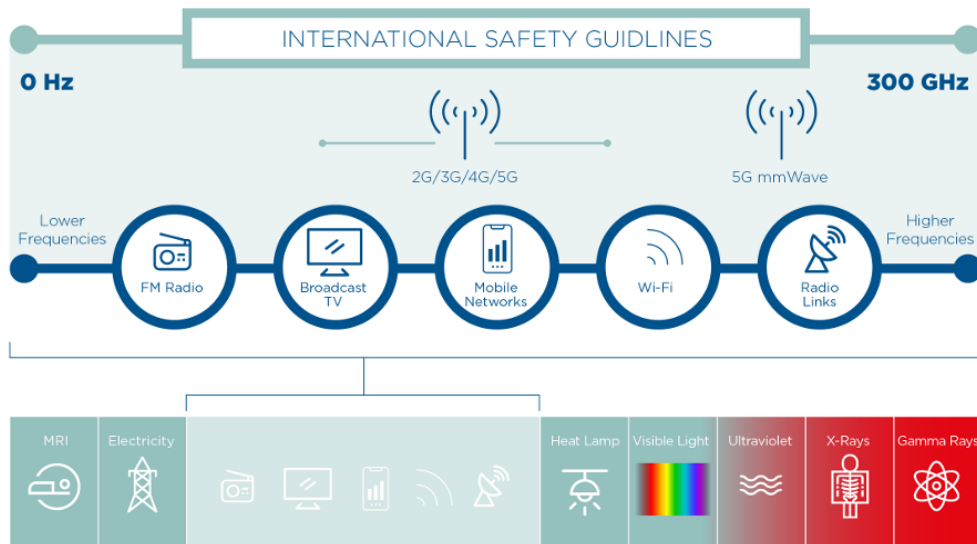
Εικόνα 1.1. Το φάσμα της Η/Μ ακτινοβολίας, στο οποίο φαίνεται η περιοχή για το 5G-mmWave coverage [1]
