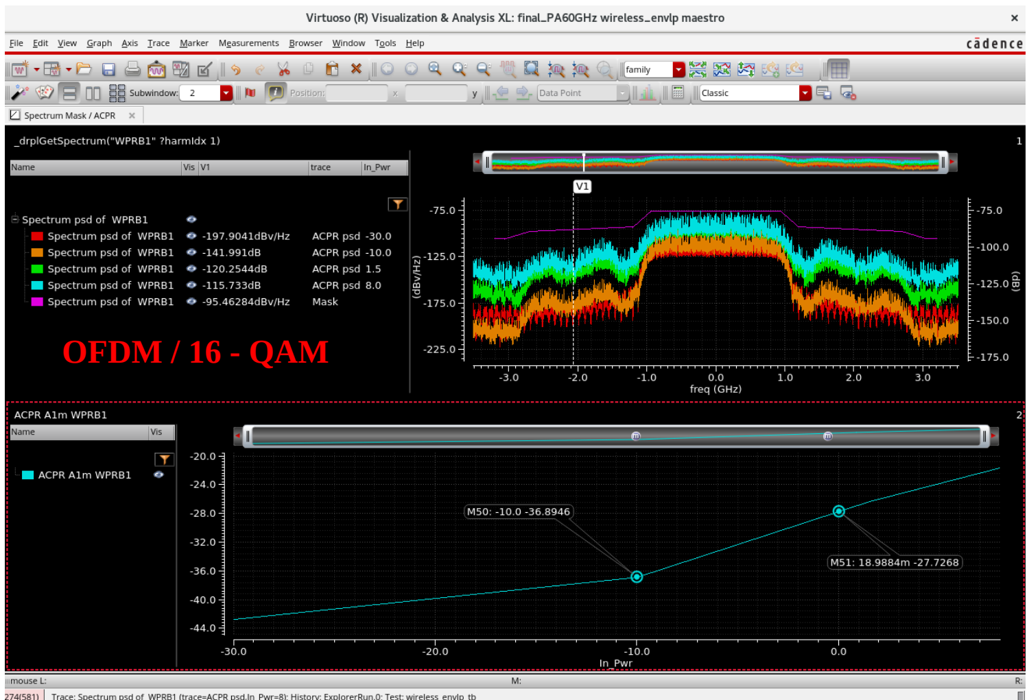
Εικόνα 7.12. Spectrum main channel power & adjacent channel power για 16-QAM διαμορφωμένο σήμα
