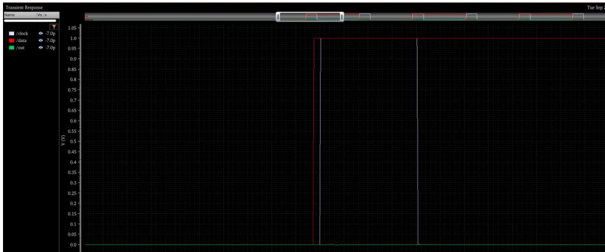
Σχήμα 2.33 Προσομοίωση όπου το setup time είναι 7 ps
