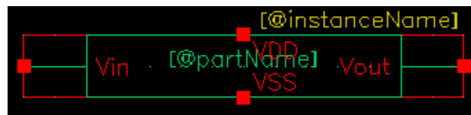
Σχήμα 3.14 Σύμβολο buffer με ονομασία BUF_B_TDC
