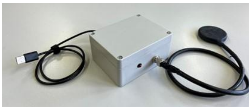
Σχήμα 2.10: Τελική συσκευή υδρόφωνου αποτελούμενη από τον αδιάβροχο ακουστικό αισθητήρα και το περίβλημα που εμπεριέχει τα ηλεκτρονικά του.
