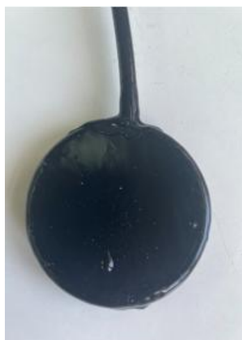
Σχήμα 2.5: PZT υδρόφωνο μετά την εμφύτευση σε υγρό καουτσούκ.
