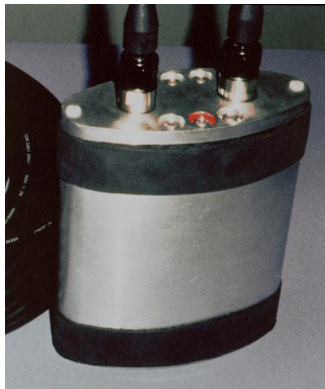
Σχήμα 1.35: Μορφομετατροπέας καμπτικών ταλαντώσεων[123].
