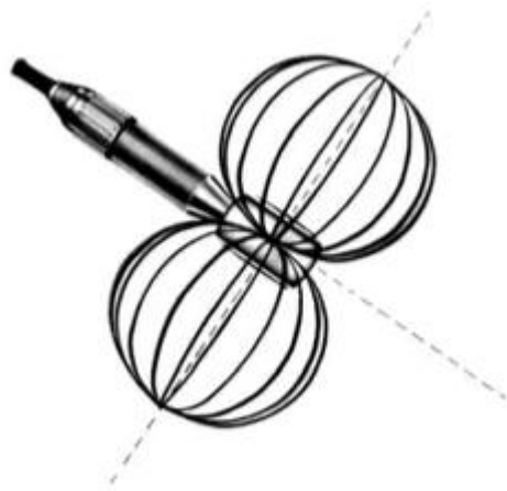
Σχήμα 1.18: Κατευθυντικότητα υψηλής συχνότητας ενός αμφίδρομου ακουστικού μορφομετατροπέα [101].
