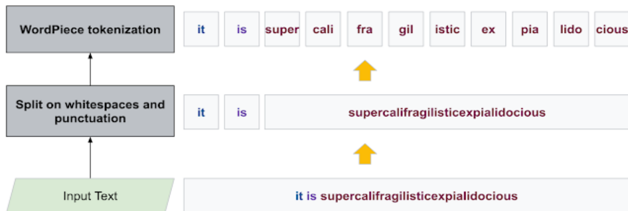
Εικόνα 20: Παράδειγμα δημιουργίας διακριτικών στο WordPiece. Πηγή: Xinying Song
