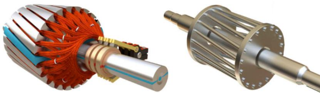
Εικόνα 1.4 : Οι δύο διαφορετικές σχεδιάσεις του δρομέα: δακτυλιοφόρος (αριστερά) ,τύπου κλωβού (δεξιά) [14].
