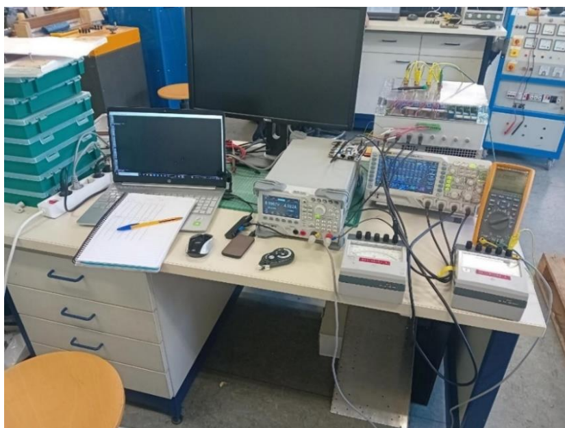
Εικόνα 3.11: Διάταξη βαθμονόμησης πλακετών ρεύματος στο εύρος [-25, 25]\text{A} .
