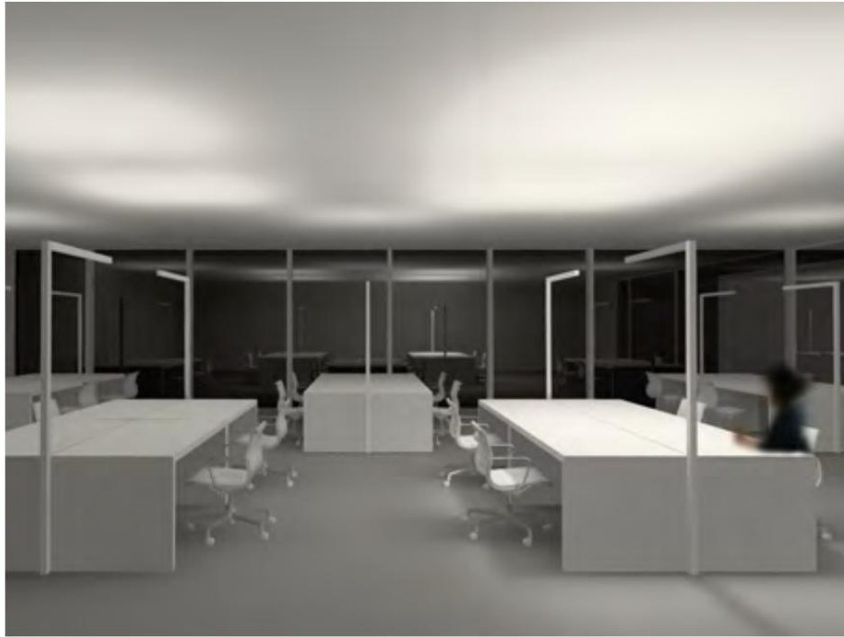
Εικόνα 12: Παράδειγμα χρήσης αισθητήρων παρουσίας. Κάθε φωτιστικό σε κάθε γραφείο περιλαμβάνει αισθητήρα, ο οποίος επικοινωνούν μεταξύ τους μέσω υπερύθρων. Εφόσον μόνο ένα γραφείο χρησιμοποιείται, το φωτιστικό του γραφείου αυτού λειτουργεί στο 100%, ενώ τα υπόλοιπα ρυθμίζονται αυτόματα ώστε να προσφέρουν έναν χαμηλότερο φωτισμό στις περιβάλλουσες επιφάνειες.[6]
