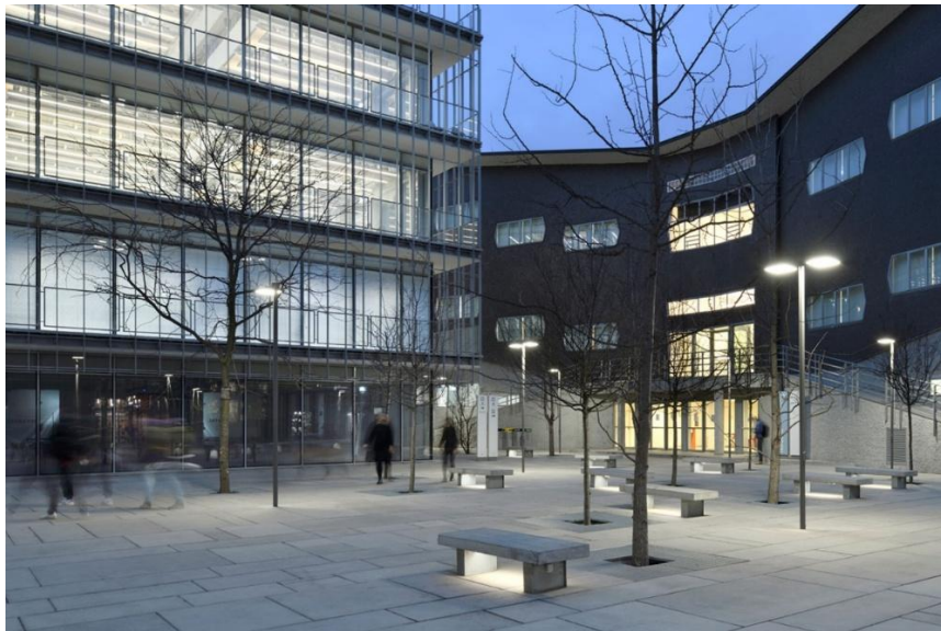
Εικόνα 49: Παράδειγμα φωτισμού πλατείας με διπλά φωτιστικά διασκορπισμένα στον χώρο και ικανοποιητικά επίπεδα ομοιομορφίας.[53]
