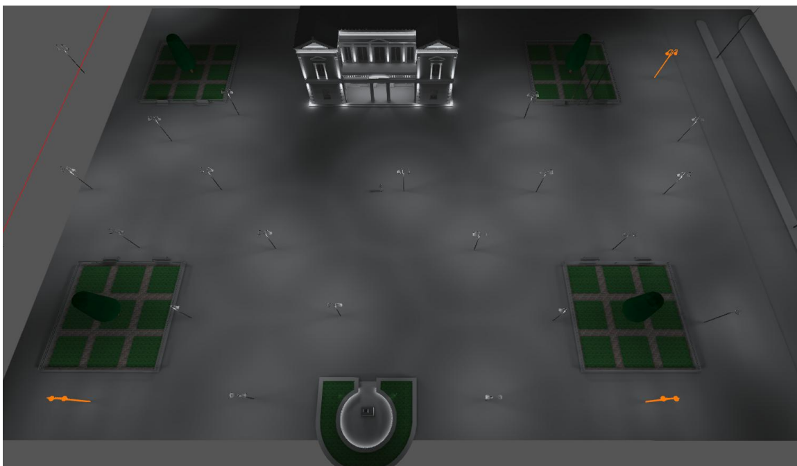
Εικόνα 69: Με πορτοκαλί εμφανίζονται οι προβολείς που στην μελέτη αντικαθίστανται με τα φωτιστικά E01. Εικόνα από το μοντέλο του φωτομετρικού λογισμικού DIALux.
