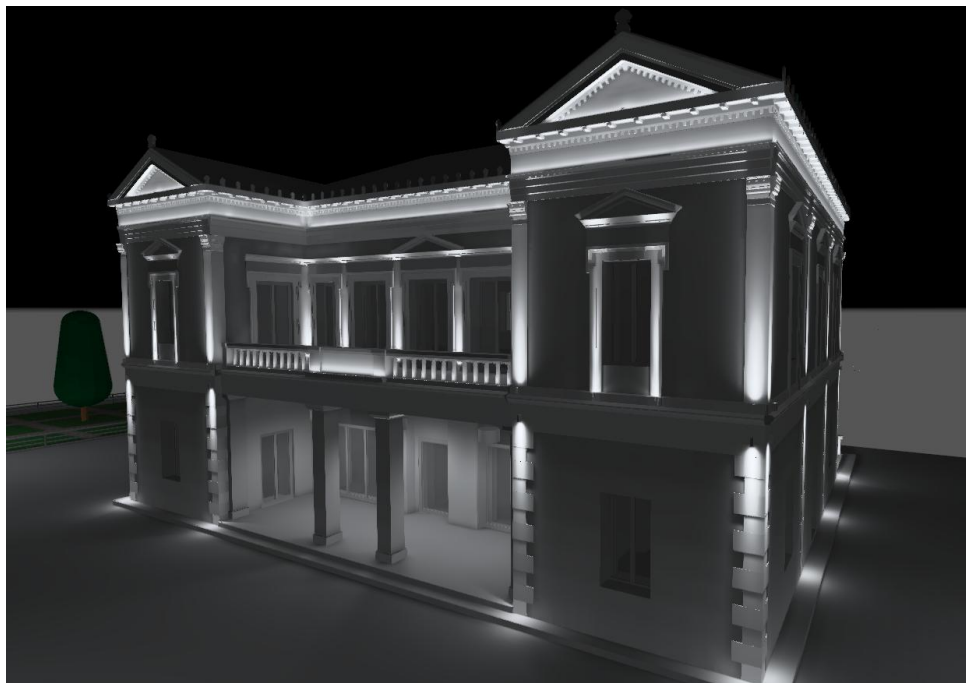
Εικόνα 80: Διαφορετική προοπτική του τελικού αποτελέσματος φωτισμού των όψεων του Δημαρχείου. Εικόνα από το μοντέλο του φωτομετρικού λογισμικού DIALux.
