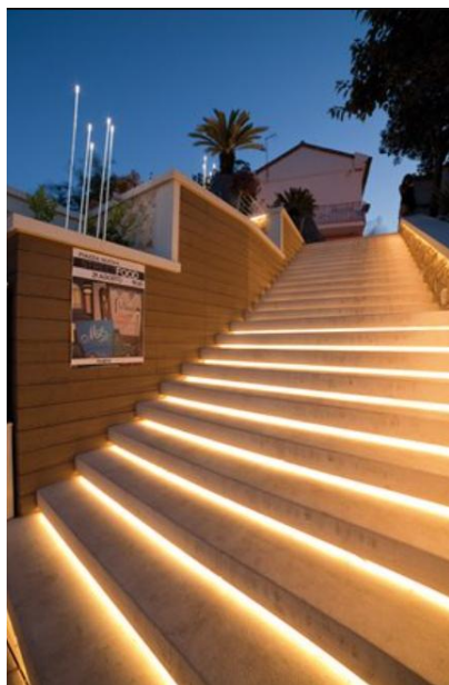
Εικόνα 22: Εφαρμογή ταινίας LED σε σκαλοπάτια εξωτερικού χώρου και σε σκοτία οροφής.[49]
