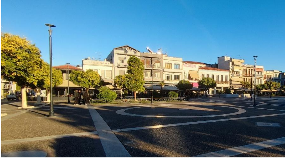
Εικόνα 47: Φωτογραφία μέρους της πλατείας, όπως ελήφθη το 2025 κατά τον επιτόπιο έλεγχο. Τα υφιστάμενα φωτιστικά τοποθετήθηκαν το 2023, αντικαθιστώντας τους διπλούς γλόμπους, και αποτελούνται από κεφαλές LED συμμετρικής κατανομής επί ιστών ύψους 5μ.
