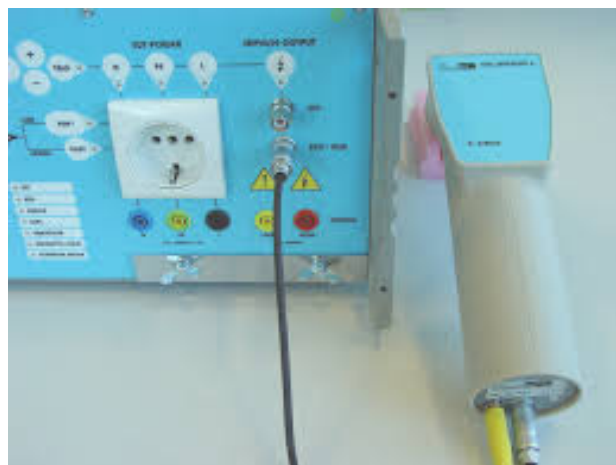
Σχήμα 2.4: Η γεννήτρια Transient 3000 της EMC Partner [2]
