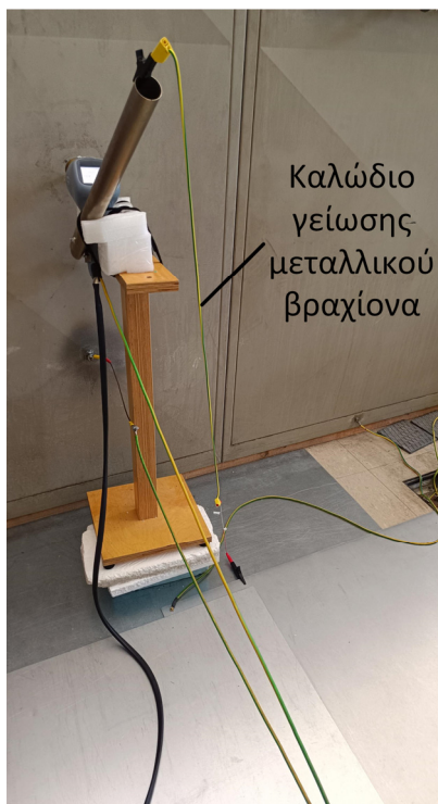
Σχήμα 5.4: Διάταξη μέτρησης για το σενάριο γειωμένου μεταλλικού βραχίονα: α) Teseq NSG 438 με το καλώδιο γείωσης της γεννήτριας ηλεκτροστατικής εκφόρτισης σε «Θέση 1» και β) EMTEST Dito με το καλώδιο γείωσης σε «Θέση 2».
