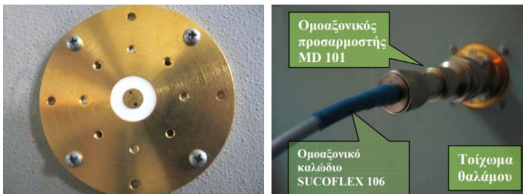
Σχήμα 2.5: Ο ομοαξονικός προσαρμοστής τοποθετημένος στη διάταξη MD 103 [2]
