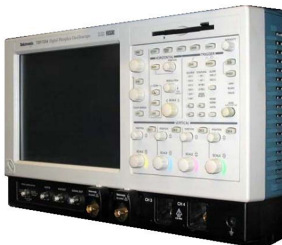
Σχήμα 2.7: Ο παλμογράφος Tektronix TDS 7254B [74]
