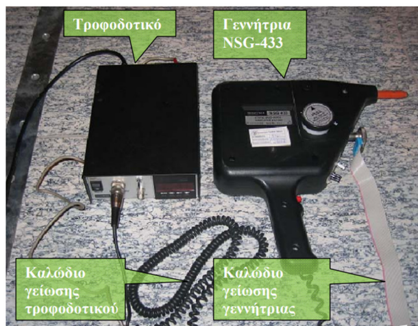
Σχήμα 2.1: Η γεννήτρια Schaffner NSG 433 [2]
