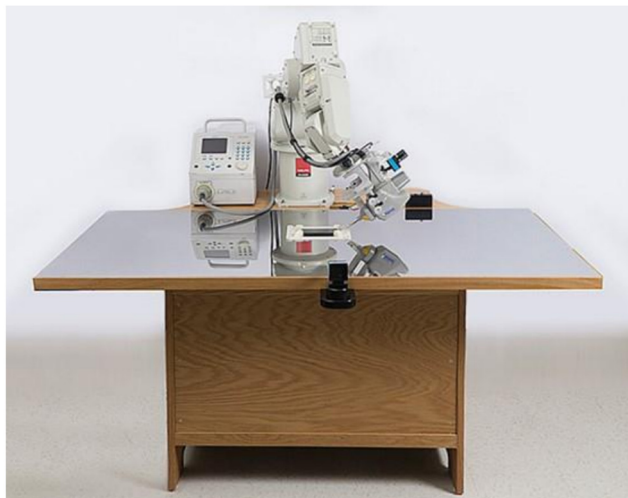
Σχήμα 1.48: Ρομποτικό σύστημα δοκιμών κατά IEC 61000-4-2 ( www.amberpi.com )
