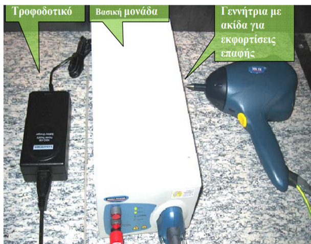
Σχήμα 2.2: Η γεννήτρια Teseq NSG 438 [2]
