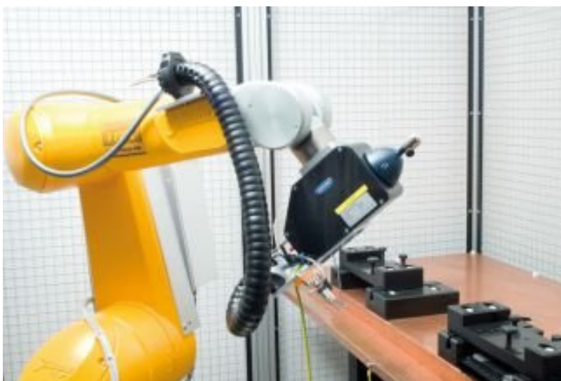
Σχήμα 1.49: NSG 439 ESD Simulator – Πλήρως αυτοματοποιημένο ρομποτικό σύστημα δοκιμών ηλεκτροστατικής εκφόρτισης [69]
