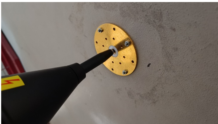
Σχήμα 3.3: Διακρίβωση της γεννήτριας ηλεκτροστατικών εκφορτίσεων με το άκρο εκφόρτισης αέρος
