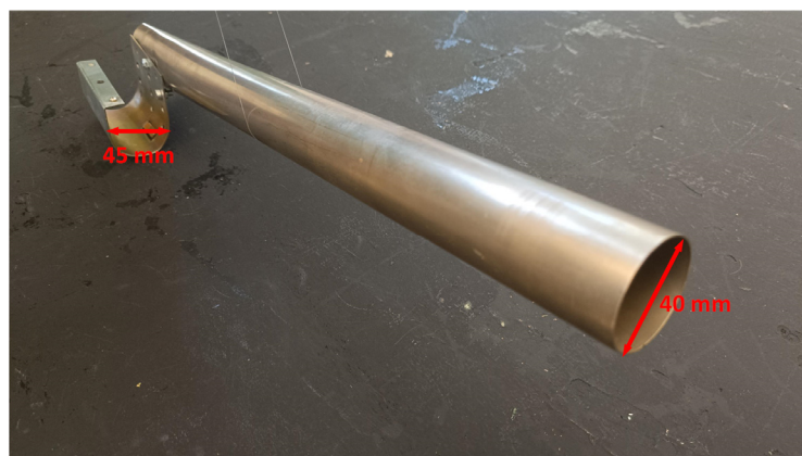
Σχήμα 5.2: Απεικόνιση της κατασκευασμένης μεταλλικής δομής που προσομοιώνει τον ρομποτικό βραχίονα: α) πρόσθια όψη και β) προοπτική πλευρική όψη
