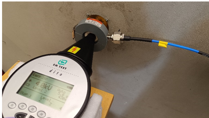
Σχήμα 2.58: Διάταξη μέτρησης σύμφωνα με την τροποποιημένη διάταξη διακρίβωσης της αναθεωρημένης έκδοσης του Προτύπου IEC 61000-4-2 (2025) [27]
