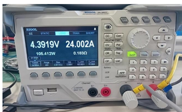
Εικόνα 3.12: Φορτίο σταθερού ρεύματος RIGOL DL3021 σε λειτουργία κατά την διαδικασία της βαθμονόμησης.
