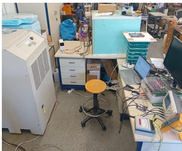
Εικόνα 3.5: Διαδικασία Βαθμονόμησης πλακετών τάσης στο εύρος τάσης εισόδου [- 400 , 400 ] Vrms .
