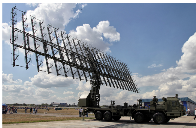
Σχήμα 2.7: Μεγάλη επίπεδη συστοιχία κεραίων ενός ρωσικού κινητού ραντάρ αεράμυνας VHF, του Nebo-M. Αποτελείται από 175 αναδιπλωμένα δίπολα. [31].
