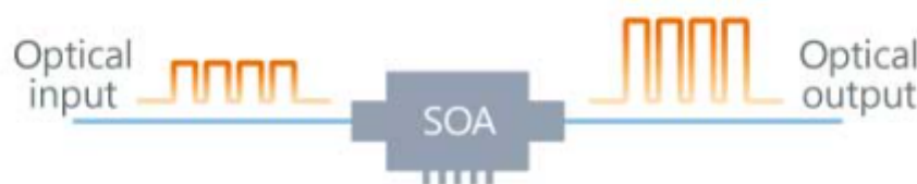
Εικόνα 2-5 : ενισχυτής SOA, πηγή [18]
