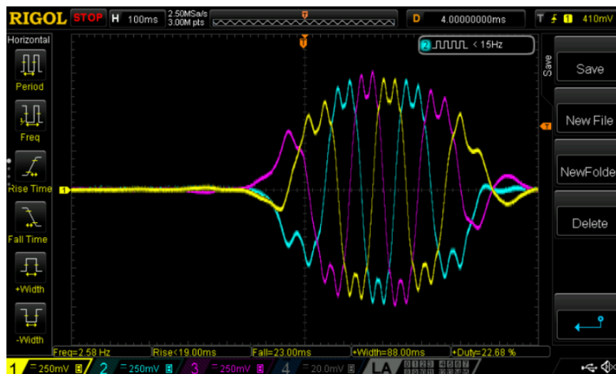
Εικόνα 4.14: Στιγμιότυπο της ΗΕΔ όπως αυτή μετρήθηκε με τη χρήση παλμογράφου [37]
