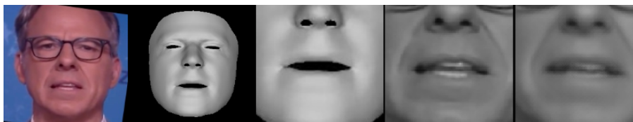
Figure 1.5.5: Από αριστερά προς τα δεξιά: Είσοδος, FAVOR, περικομμένο στόμα από το βίντεο εισόδου, περικομμένο στόμα rendered αποτέλεσμα, περικομμένο στόμα από το πραγματικό βίντεο σε κλίμακα του γκρι, περικομμένο στόμα από την ανακατασκευασμένη έξοδο.
