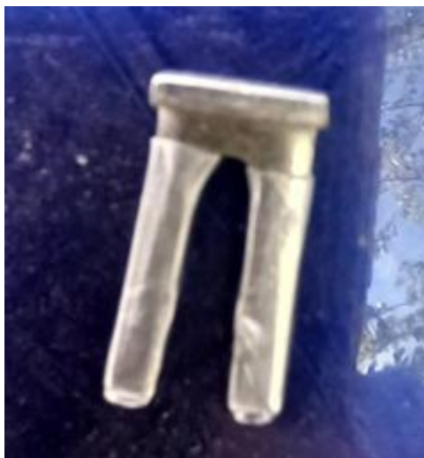
Εικόνα 3.22 Τοποθέτηση μονωτικού υλικού στον γεφυροσύνδεσμο [34]
