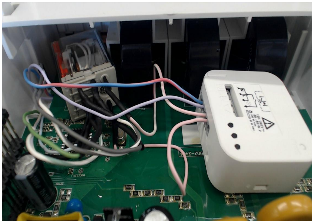
Εικόνα 3.11 Τηλεχειρισμός on-off στα πηνία εντάσεως σε ψηφιακό τριφασικό μετρητή [34]
