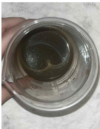
Σχήμα 3.9: Τελική μορφή διαλύματος νανοςωματιδίων Ag.
