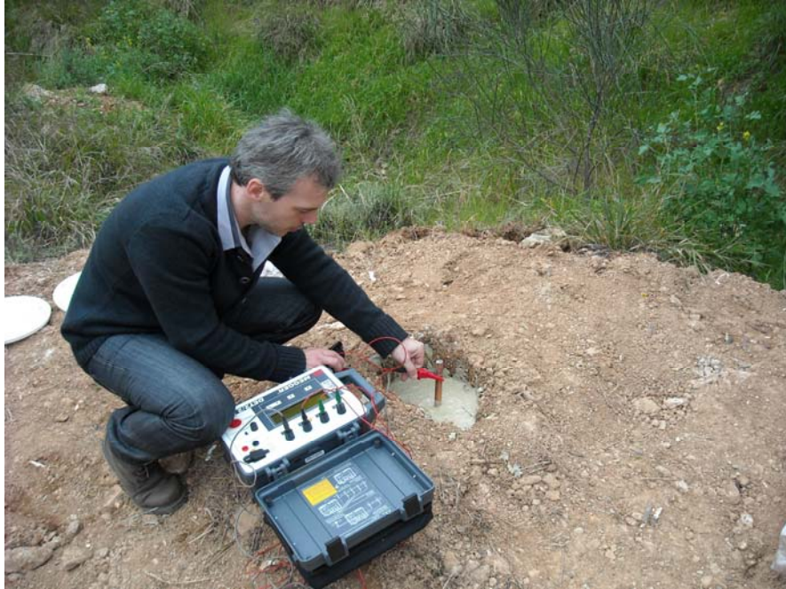
Εικόνα 5.10: Σύνδεση του γειωσόμετρου σε ηλεκτρόδιο γείωσης.
