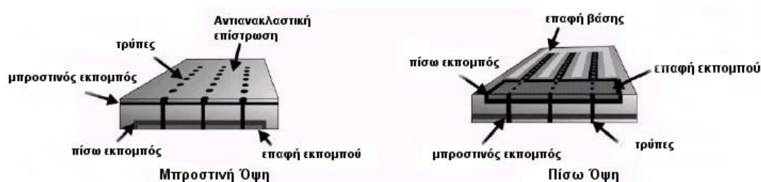
Σχήμα 3.9. Σχηματική δομή του φ/β στοιχείου EWT (Emitter Wrap Through). Το αριστερό σχήμα δείχνει την μπροστινή όψη του στοιχείου όπου φαίνονται οι τρύπες που ενώνουν ηλεκτρικά τον μπροστινό με τον πίσω εκπομπό. Το δεξί σχήμα δείχνει τα ηλεκτρόδια της βάσης και των εκπομπών. Οι τρύπες ανοίγονται με laser [40].
