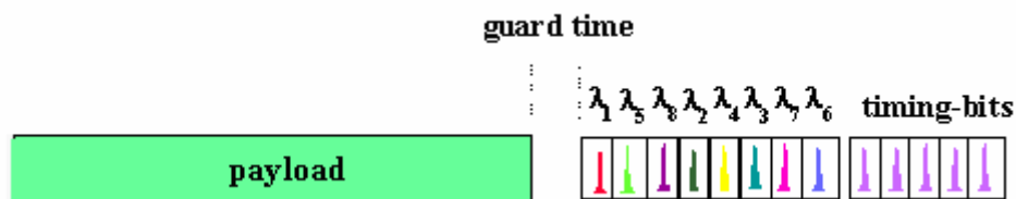
Σχήμα 3. Σχηματική αναπαράσταση επικεφαλίδας πακέτου αποτελούμενη από Οπτικά M -αδικά σύμβολα. Διακρίνονται επίσης μερικά bits στην αρχή της μετάδοσης, για λόγους χρονισμού των bits, καθώς και ένας «χρόνος προστασίας» (guard time) απαραίτητος για τον διαχωρισμό της επικεφαλίδας από το ωφέλιμο φορτίο (payload).
