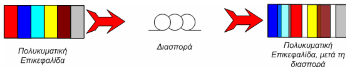
Σχήμα 4. Επίδραση οπτικής ίνας με διασποράς σε πολυκυματική επικεφαλίδα. Η σειρά των μηκών κύματος έχει αλλάξει ενώ ταυτόχρονα υπάρχουν αλληπικαλύψεις.
