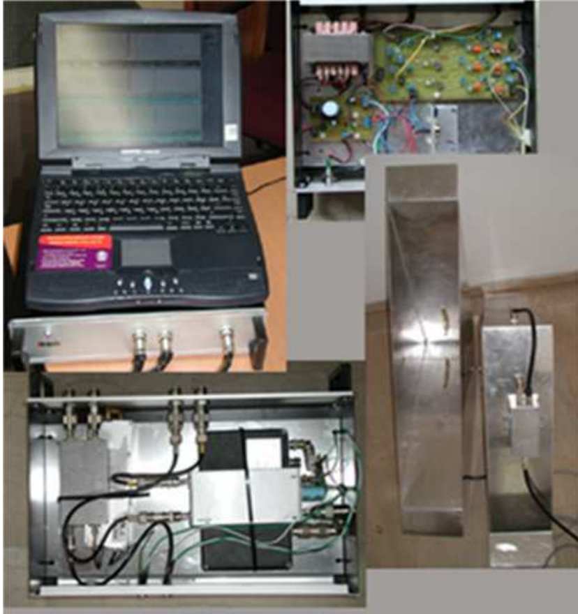
Σχήμα 2.4: Φωτογραφία του ΣΩΖΩΝ II· διακρίνεται ο υπολογιστής και το τμήμα χαμηλών συχνοτήτων (πάνω αριστερά), το εσωτερικό του τμήματος χαμηλών συχνοτήτων και τροφοδοσίας (πάνω δεξιά), οι κεραίες των 430 MHz και 2.45 GHz(κάτω δεξιά) και το εσωτερικό του τμήματος 430 MHz και 2.45 GHz
