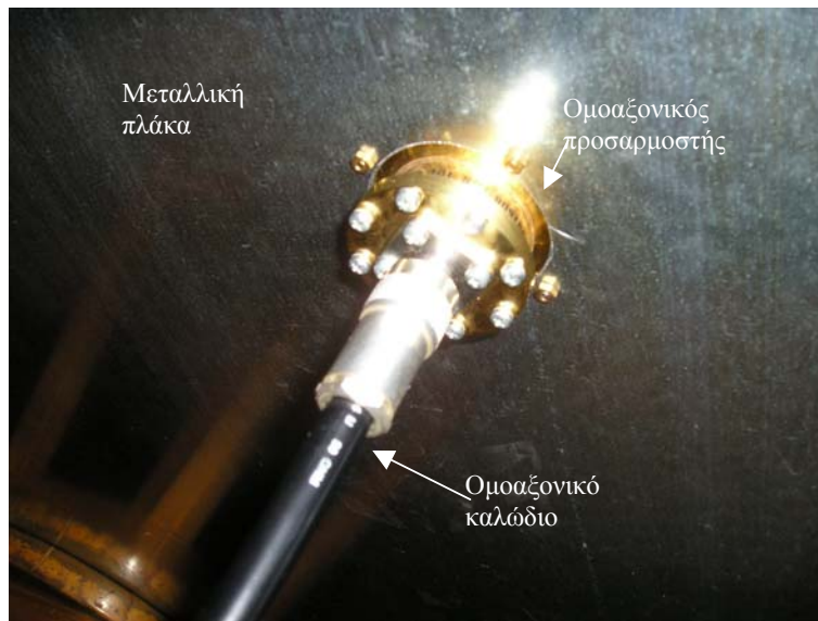
Σχήμα Π.6: Ο ομοαξονικός προσαρμοστής τοποθετημένος στη διάταξη
