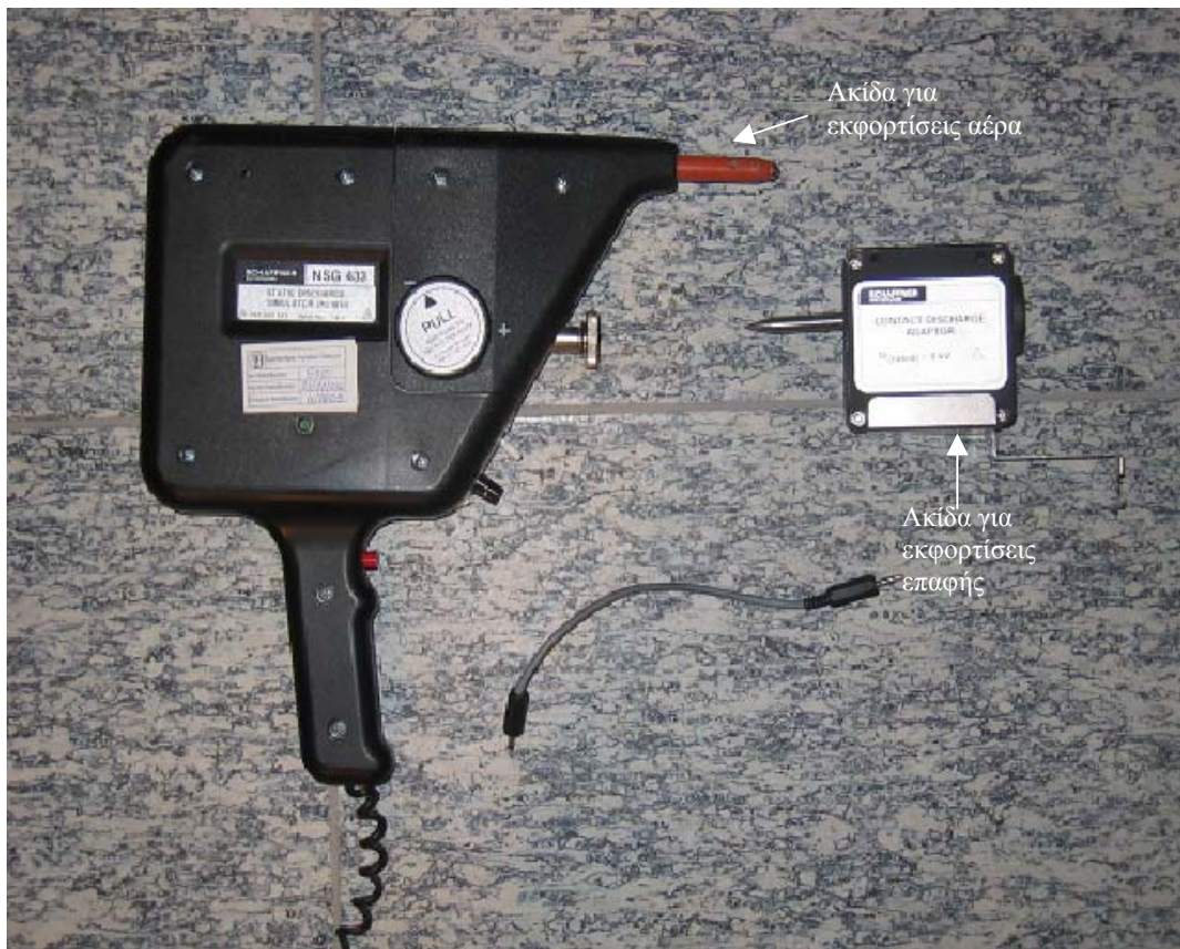
Σχήμα Π.2: Ακίδες για εκφορτίσεις μέσω αέρα και επαφής για τη γεννήτρια NSG-433
