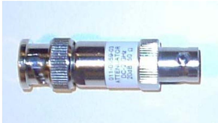
Σχήμα Π.7: Ο εξασθενητής (attenuator) 011-0059-03 της Tektronix
