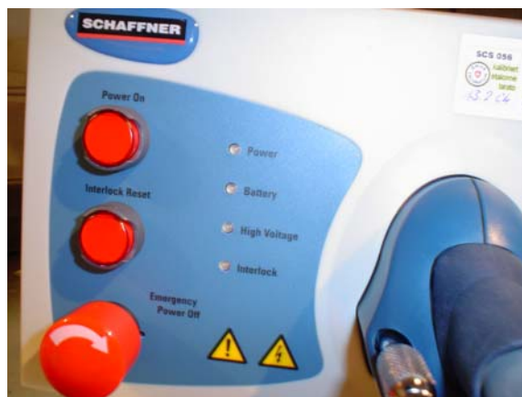
Σχήμα Π.4: Η βασική μονάδα της γεννήτριας με τα μπουτόν και τις ενδεικτικές λυχνίες
