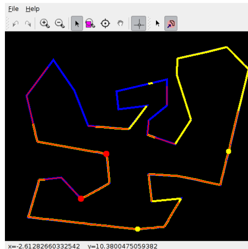
Σχήμα 5.5: Ένα τρέξιμο του vispack που με δύο φύλακες δίνει κάλυψη 87% του βέλτιστου.
