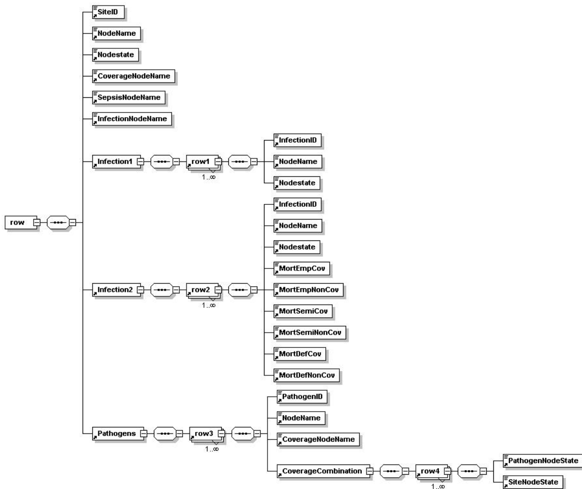
Σχήμα 7-6: Χρήση της XML για την αναπαράσταση ιεραρχικών δομών
