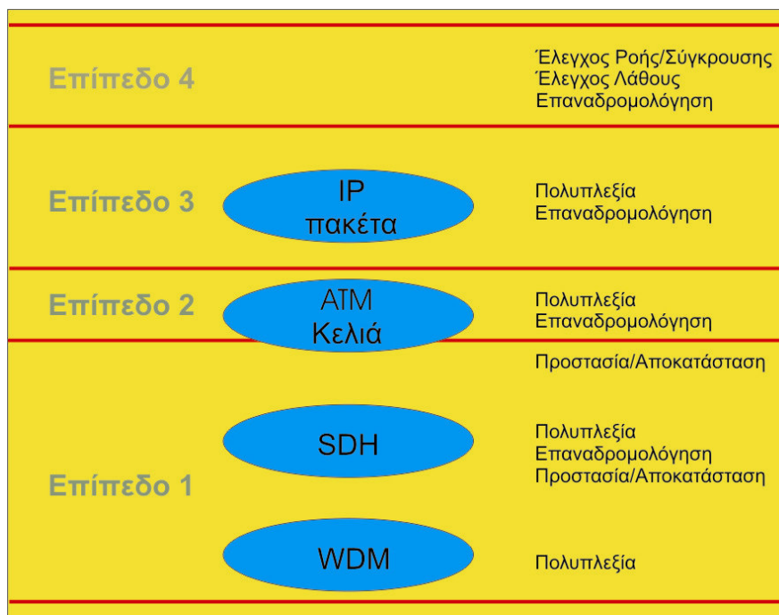
Σχήμα 1.7: Πανομοιότυπες διπλές λειτουργίες κατά τη μετάδοση IP πακέτων σε ένα δίκτυο μέσω της τεχνολογία IP-ATM.
