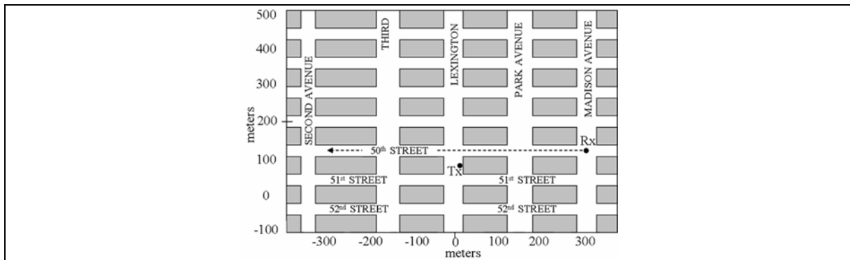
Σχήμα 3.17 Δεύτερη περιοχή μελέτης (Manhattan), που χρησιμοποιείται για τη σύγκριση των αποτελεσμάτων ραδιοκάλυψης του προγράμματος ‘MicroRaCoP’ με αντίστοιχα δημοσιευμένα θεωρητικά αποτελέσματα και μετρήσεις [6, 16].
