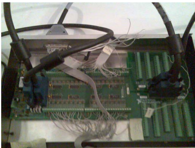
Σχήμα 19 - Δύο συνδετήρες και πολυπλέκτης με τα καλώδια για επικοινωνία μεταξύ τους και με τους υπολογιστές. Βρίσκονται σε μεταλλικό κουτί που λειτουργεί μονωτικά αλλά αποτελεί και γείωση
