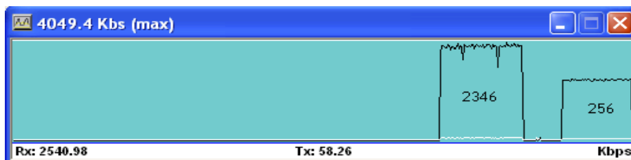
Σχήμα 27-3: Μέτρηση throughput με δυο διαφορετικές τιμές στο fragmentation threshold
