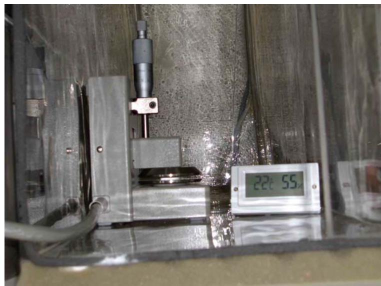
Σχήμα Π-3.13: Το κελί μετρήσεων στερεών και δεξιά του το όργανο μέτρησης θερμοκρασίας και υγρασίας του χώρου. Διακρίνεται το λευκό δισκίο μεταξύ των μεταλλικών πλακών.
