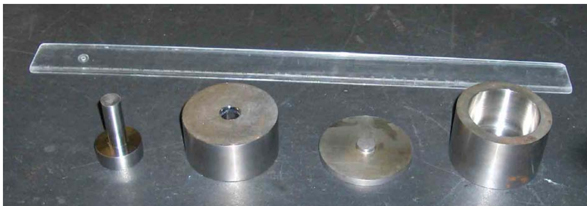
Σχήμα Π-3.1: Καλούπι από ανοξείδωτο χάλυβα. Από αριστερά προς τα δεξιά: έμβολο, μήτρα, βάση και βοηθητικό στοιχείο αποδέσμευσης δείγματος.
