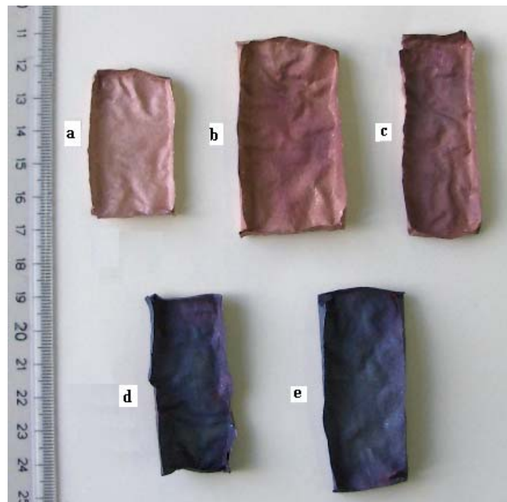
Σχήμα I-3.8: Χρωματικές διαφορές δοκιμίων Cu. Δείγμα αναφοράς (a) και δείγματα μετά από θέρμανση παρουσία SF 6 σε θερμοκρασία 300°C (b), 330°C (c), 355°C (d) και 385°C (e).
