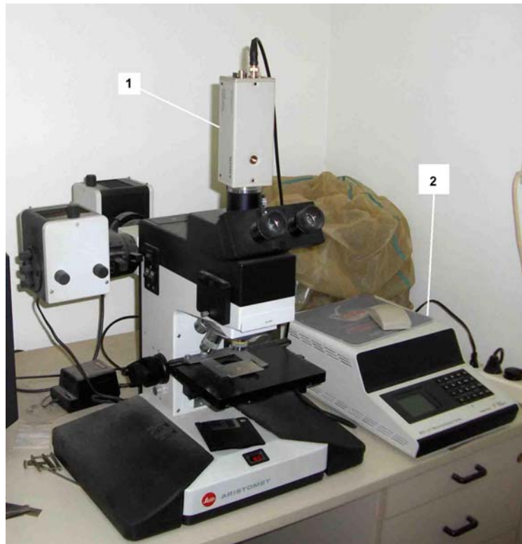
Σχήμα Β-9: Το μεταλλογραφικό μικροσκόπιο Leitz Aristomet. Διακρίνεται επίσης η ψηφιακή κάμερα (1) και η μονάδα ελέγχου της διάταξης μετρήσεων μικροσκληρότητας (2).
