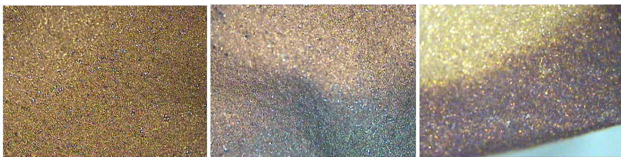
Σχήμα I-3.9: Φωτογραφίες επιφάνειας δειγμάτων χαλκού από οπτικό μικροσκόπιο (μεγέθυνση x25). Στην αριστερή φωτογραφία εικονίζεται δείγμα αναφοράς, ενώ στη μεσαία και στη δεξιά μερικώς προσβεβλημένα δείγματα.
