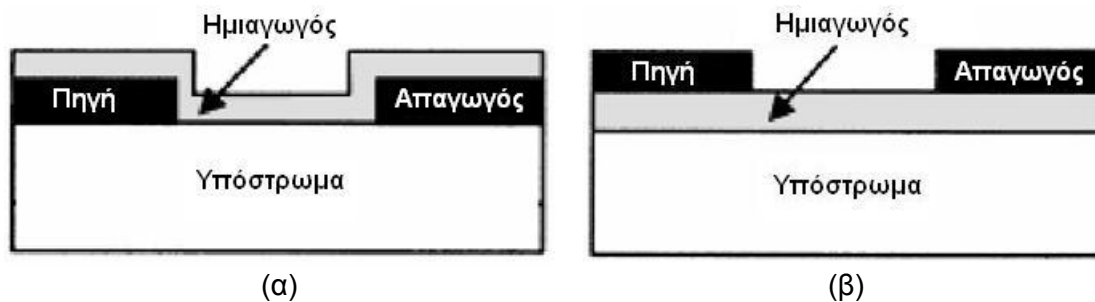
Σχήμα 3.1: Ηλεκτρόδια (α) πάνω στο μονωτή και (β) πάνω στο ενεργό κανάλι.
