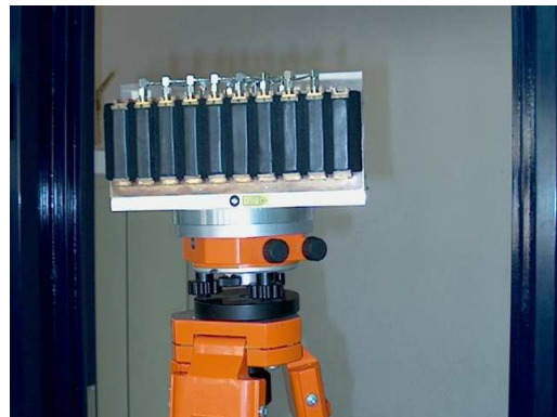
Σχήμα 3.5: Ομοιόμορφες γραμμικές στοιχειοκεραίες πομπού (αριστερά) και δέκτη (δεξιά)
