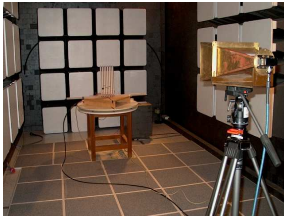
Σχήμα 3.6: Μέτρηση βαθμονόμησης στοιχειοκεραίας πομπού
