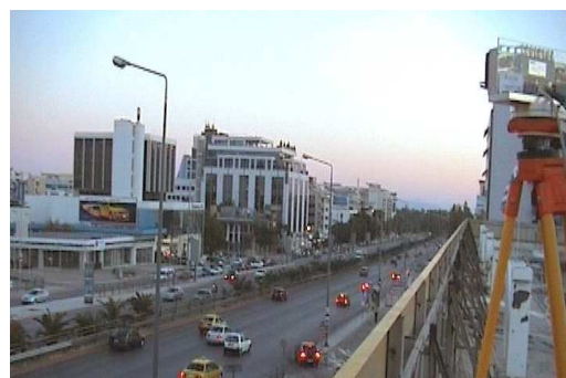
Σχήμα 3.9: Το περιβάλλον μέτρησης στη λεωφόρο Συγγρού όπως φαίνεται από τον πομπό που βρίσκεται στο επίπεδο του δρόμου (αριστερά) και τον δέκτη (δεξιά) τοποθετημένο στην ταράτσα της Ελφινκο Α.Ε
