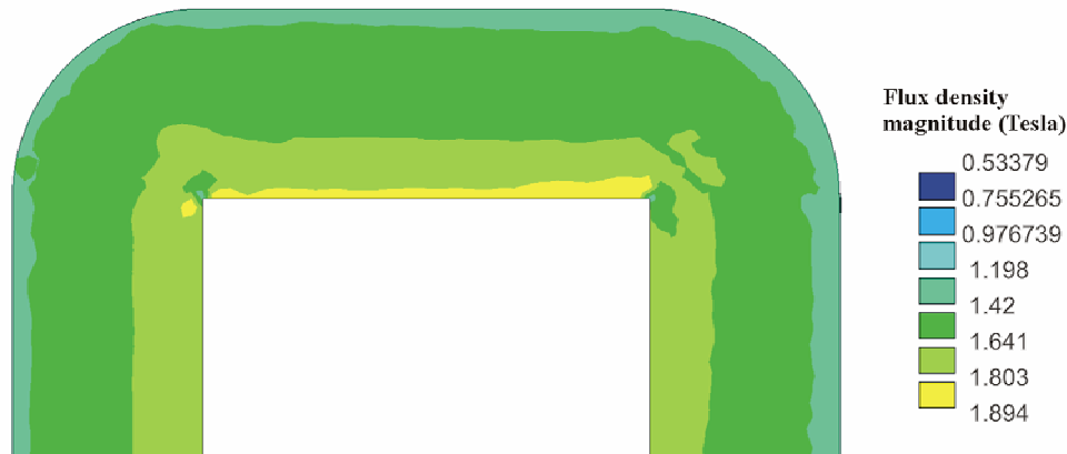
Σχήμα 7.7: Λεπτομέρεια από την κατανομή της μαγνητικής επαγωγής τυλιχτού πυρήνα ( B=1,66 T).
