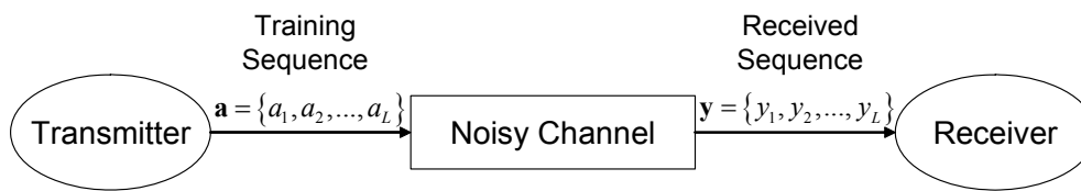
Σχήμα 2-3. Βασικό μοντέλο για την εκτίμηση του SINR
