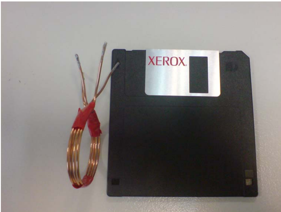
Σχήμα 7.2.10. Τρίτος μετασχηματιστής με 2 σπείρες.
