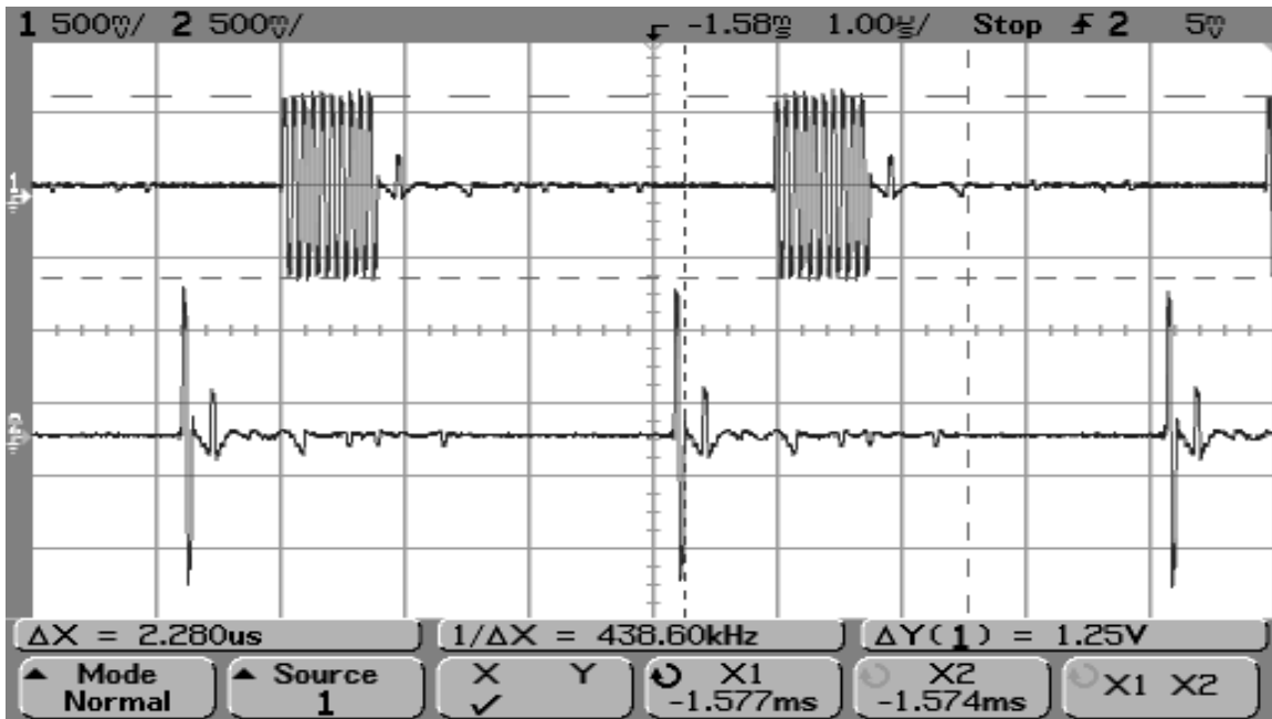
Σχήμα 8.2.26. Επίδοση αλγορίθμου PR σε ομοαξονικό κανάλι σε χρονικό παράθυρο 10μs. Έμφαση στην απόκλιση στην ακρίβεια συγχρονισμού.
