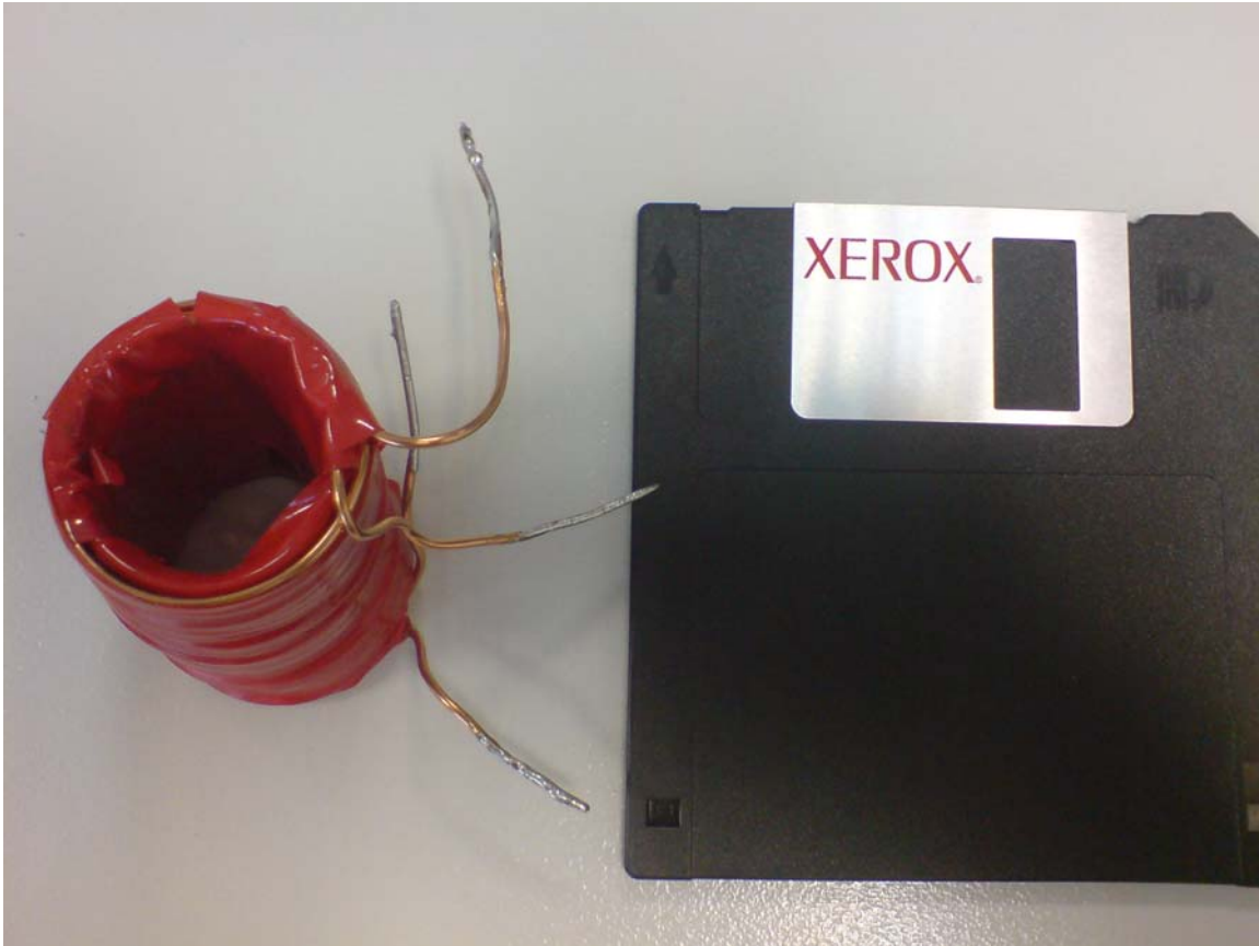
Σχήμα 7.2.8. Πρώτος μετασχηματιστής με 24 σπείρες.
