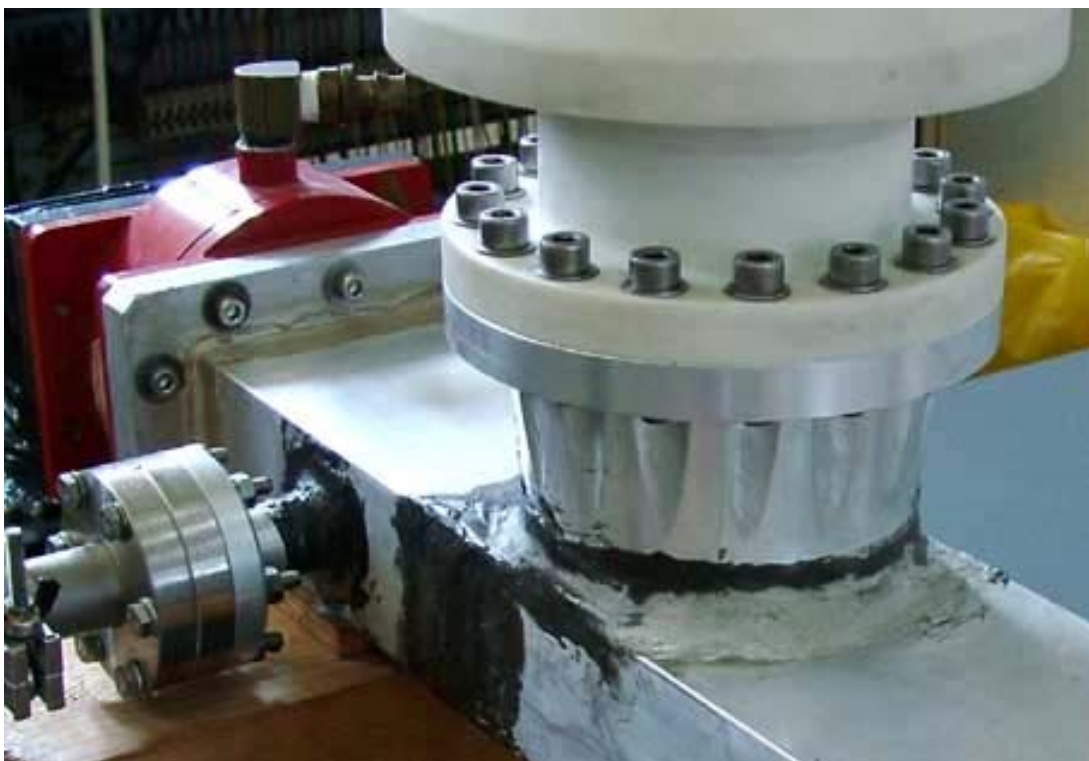
Εικ. 5.26: Επικάλυψη με ρητίνες, προκειμένου να μειωθούν οι διαρροές στις ενώσεις της λυχνίας.
