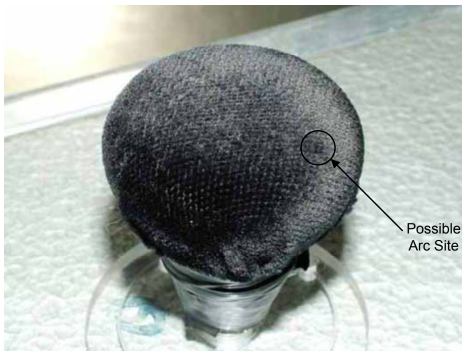
Εικ. 6.85: Κάθοδος με ύφασμα, d_{AK}=15\text{mm} , \sim 100 κρούσεις. Σημειώνεται το μόνο ευκρινές σημάδι που φάνηκε μετά από εξέταση του υφάσματος.
