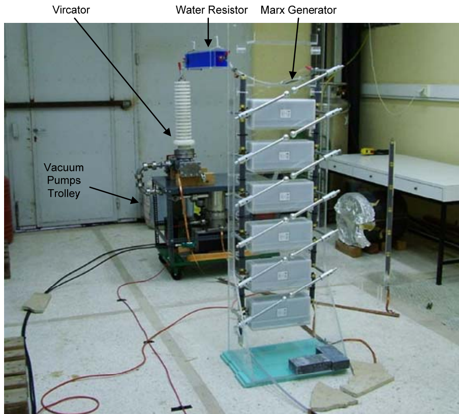
Εικ. 7.23: Φωτογραφία της πειραματικής διάταξης με πολυβάθμια γεννήτρια Marx.
