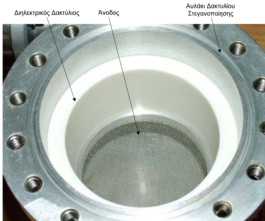
Εικ. 5.15: Άποψη της ανόδου και του σημείου τοποθέτησης του μονωτήρα διέλευσης.
