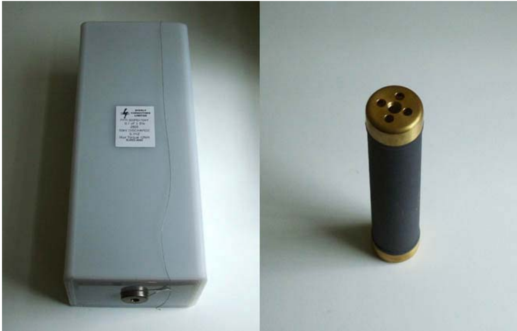
Εικ. 7.2: Πυκνωτής κρουστικής εκφόρτισης 50kV (αριστερά) και αντίσταση 70kV, 55W (δεξιά). Οι αντιστάσεις του 1MΩ και των 10MΩ έχουν ίδιες διαστάσεις.
