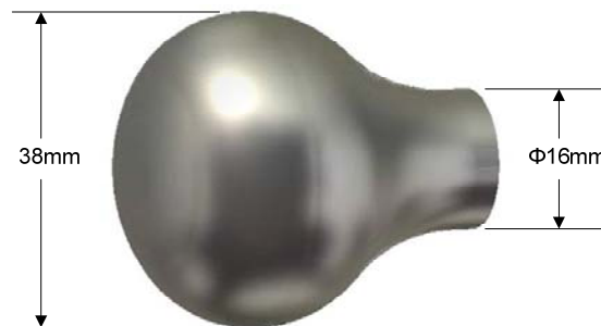
Εικ. 7.9: Ο σχεδιασμένος ακροδέκτης σπινθηριστή.
