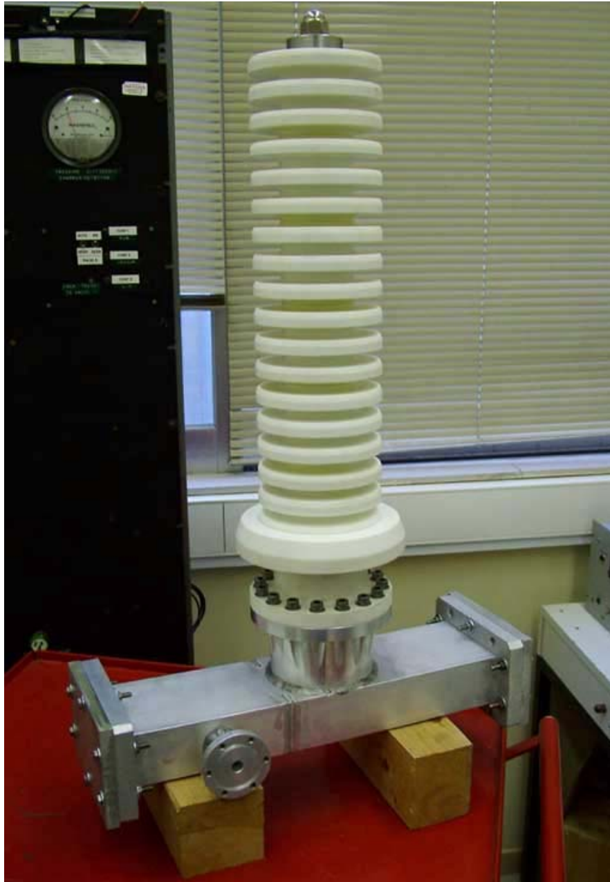
Εικ. 5.2: Ο Viricator, όπως παρελήφθη από το μηχανουργείο.
