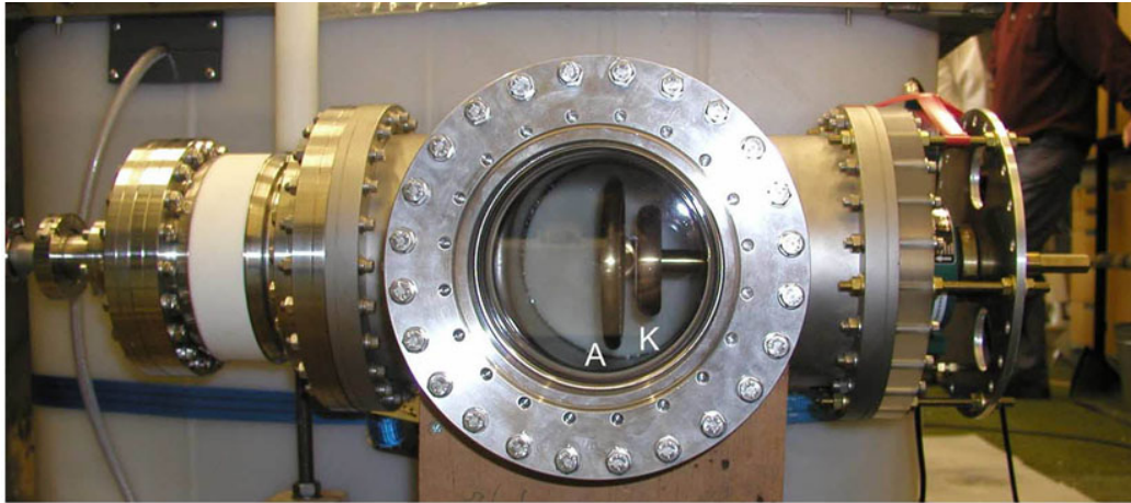
Εικ. 4.23: Vircator τύπου Reflex Triode. Ο παλμός οδηγείται στην άνοδο. Αριστερά είναι προσαρμοσμένη η αντλία κενού (δεν διακρίνεται), μέσω ενός διηλεκτρικού κεραμικού συνδέσμου, για ηλεκτρική απομόνωση της αντλίας από την κρουστική γη [116].
