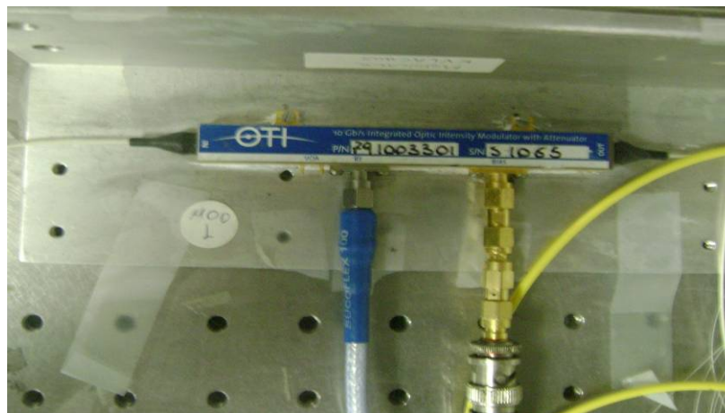
Εικόνα 4. 28: Οπτικός διαμορφωτής (Mod Ti:LiNbO 3 )
