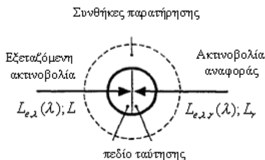
Σχήμα 4.3.1 Πειραματική διάταξη οπτικής ταύτισης, σε επίπεδο αρχής [57].
