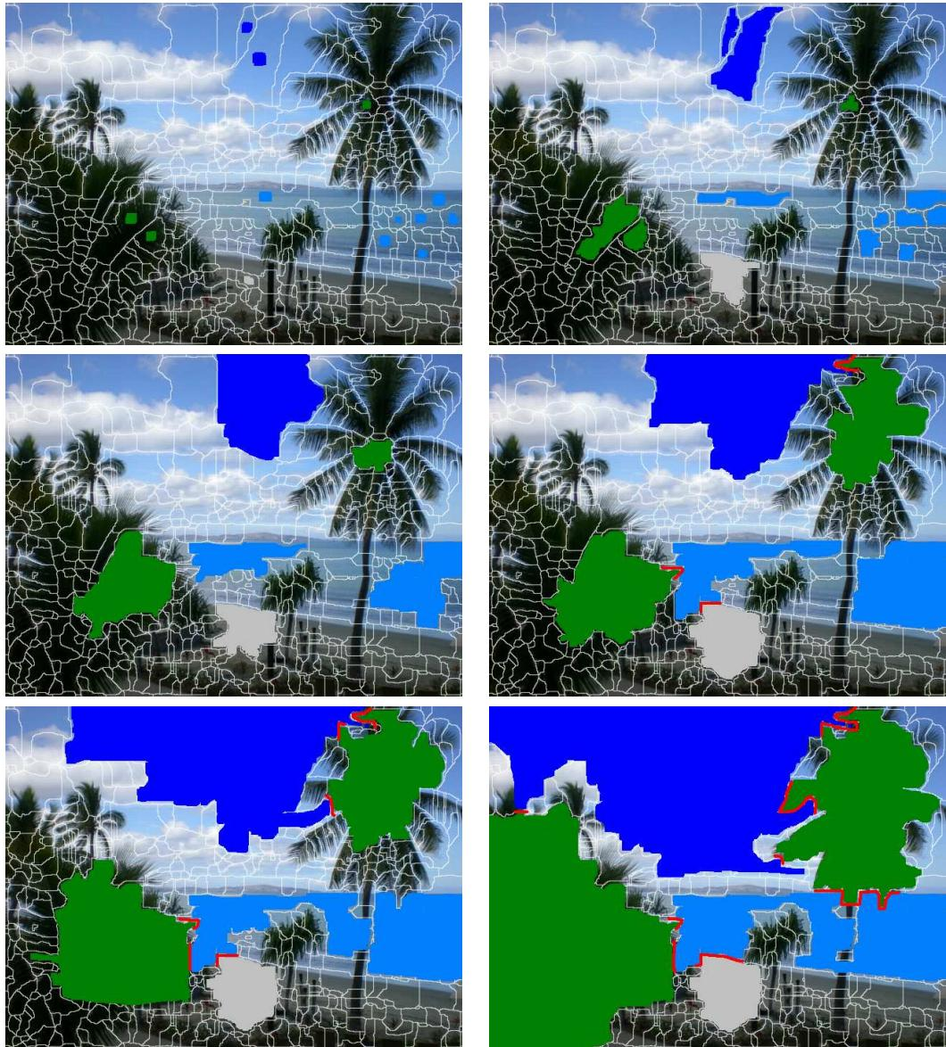
**Σχήμα 4.6:** Σχηματική αναπαράσταση του σημασιολογικού πλημμυρισμού εικόνας.
