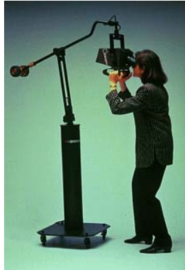
Εικόνα 5: Σύστημα VR με μηχανικούς αισθητήρες εντοπισμού
