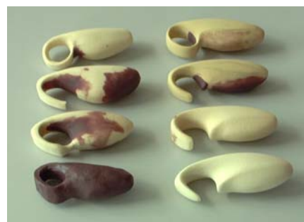
Εικόνα 165: Έλεγχος αφής της «Σφήκας» και διαδοχικά στάδια υλοποίησης
