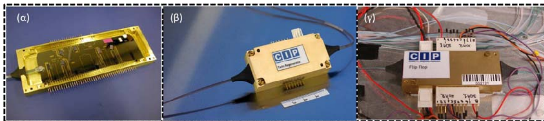
Σχήμα 15: α) 3R αναγεννητής, β) 2R αναγεννητής & μετατροπέας μήκων κύματος, γ) οπτικός μανδαλωτής
