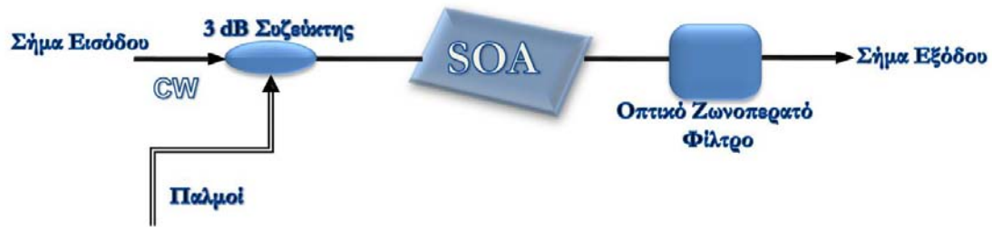
Σχήμα 41: Διάταξη για τον καθορισμό του χρόνου ανάκαμψης του SOA.
