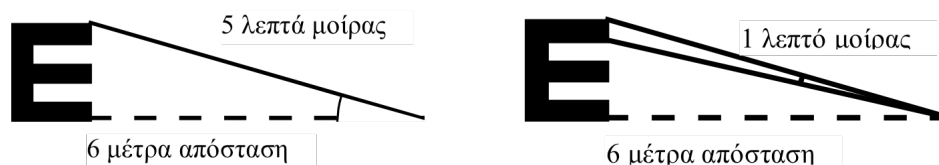
Σχήμα 2-14. Καθορισμός αποστάσεων και οπτικών πεδίων [19].
