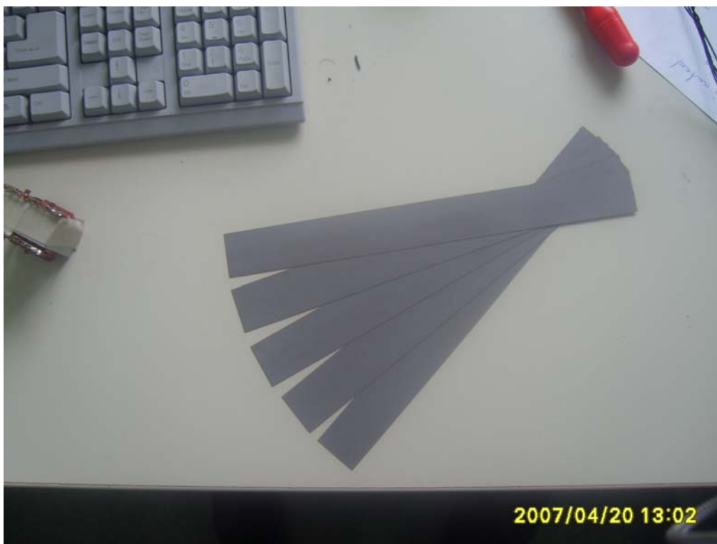
Σχήμα 3.21: Δοκίμια μαγνητικής λαμαρίνας που μετρήθηκαν στην διάταξη Epstein
