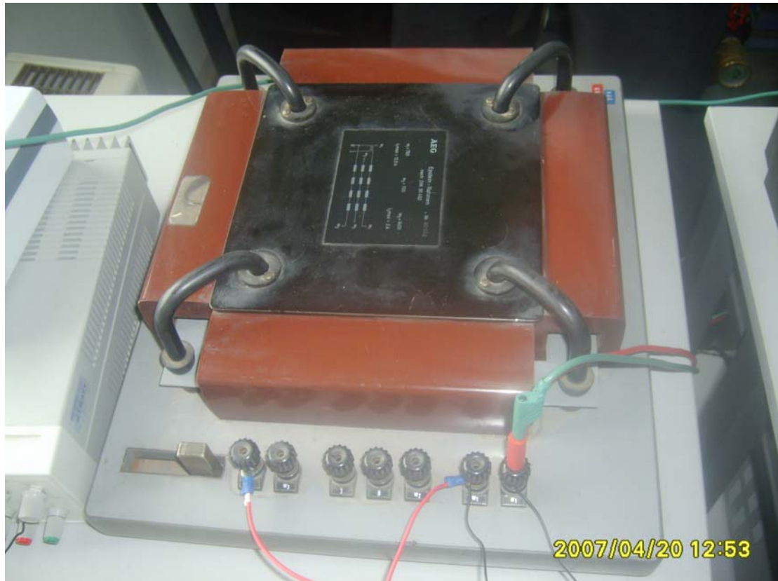
Σχήμα 3.4: Διάταξη Epstein που χρησιμοποιήθηκε στο εργαστήριο για τις μετρήσεις
