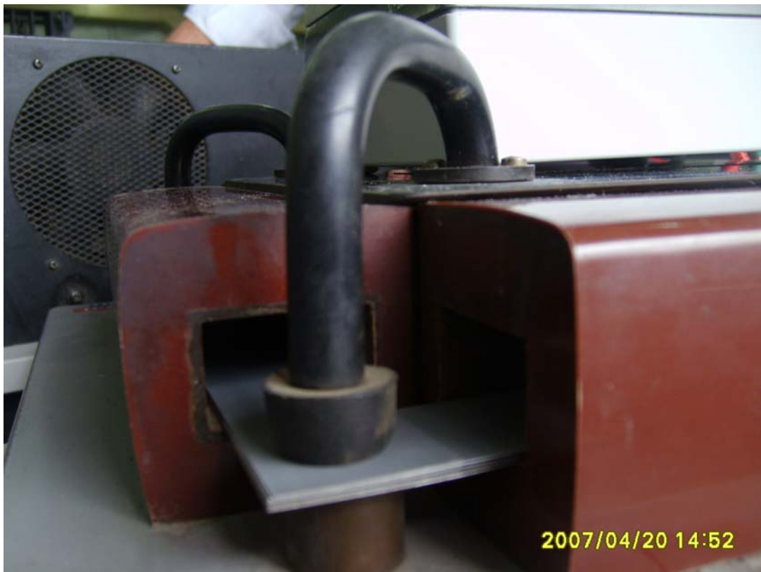
Σχήμα 3.8: Τοποθέτηση δοκιμίων (φύλλων σιδηρομαγνητικού υλικού) στην διάταξη Epstein
