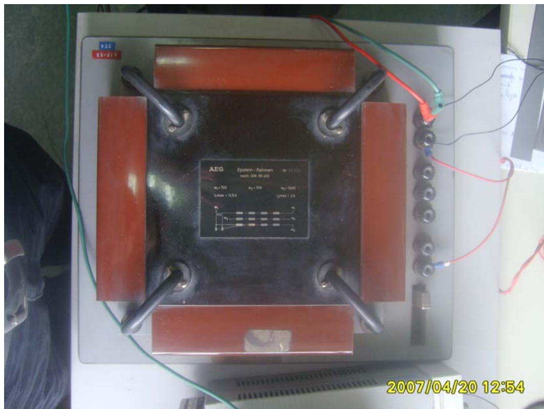
Σχήμα 3.3: Διάταξη Epstein που χρησιμοποιήθηκε στο εργαστήριο για τις μετρήσεις.
