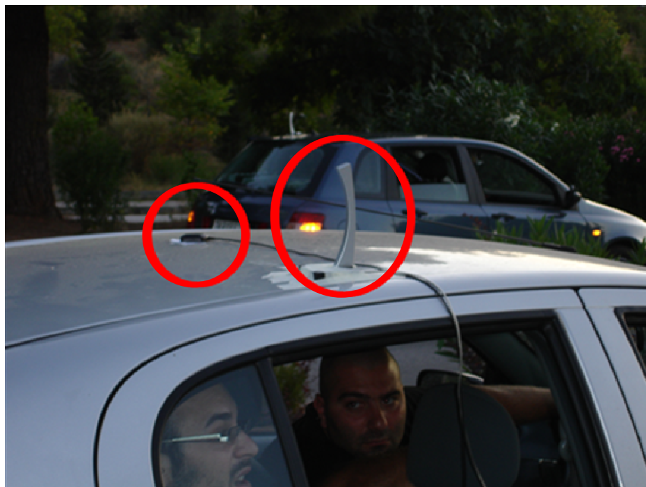
Εικόνα 66: Απλό USB GPS και κεραία ασυρμάτου δικτύου
