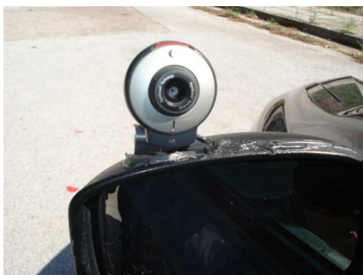
α) USB κάμερες στους εμπρόσθιους καθρέφτες
