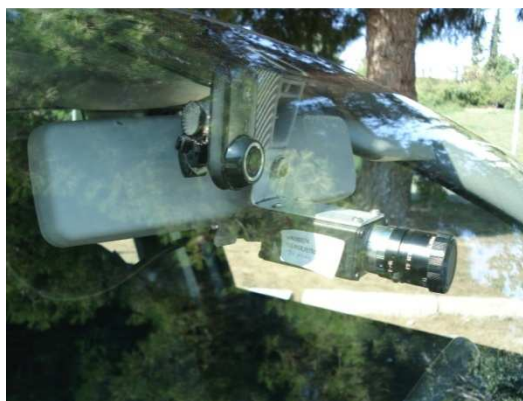
γ) Εμπρόσθιες USB & Firewire κάμερες
