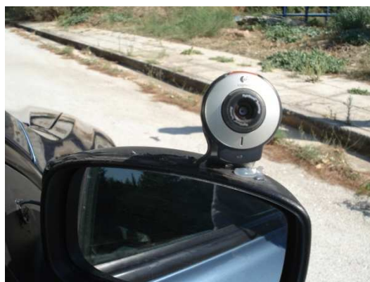
α) USB κάμερες στους εμπρόσθιους καθρέφτες
