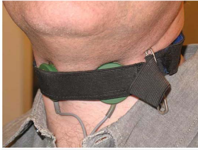
Σχήμα 37: Λαρυγγογράφος και τοποθέτησή του στον ομιλητή. Πηγή: Inst. of Phonetic Sciences in Amsterdam.
