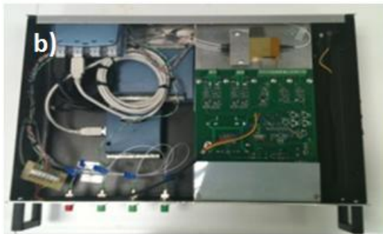
Σχήμα 63: a) Λογισμικό για τη μεταβολή των παραμέτρων του αμιγώς οπτικού μετατροπέα μήκους κύματος, b) Ολοκλήρωση φωτονικών και ηλεκτρονικών στοιχείων, c) Φασματική απόκριση των συμβολόμετρων καθυστέρησης για διαφορετικές τιμές τάσης στα θερμαντικά στοιχεία
