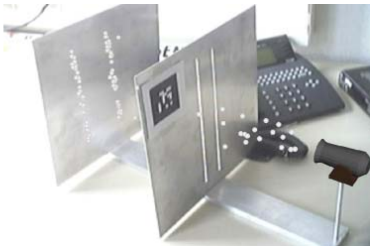
Εικόνα 3.25. Η αρχική πειραματική διάταξη για την αναπαράσταση του πειράματος των δύο σχισμών περιελάμβανε μια απλή μεταλλική κατασκευή και σειρά σεναρίων επαυξημένης πραγματικότητας (εδώ διακρίνονται τα «σωματίδια» που προσπίπτουν στο ενδιάμεσο πέτασμα με τις σχισμές) ανάλογα με την γεωμετρία του ενδιάμεσου τοιχώματος.
