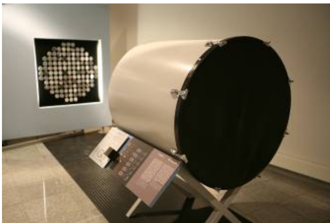
Εικόνα 5.3 Το έκθεμα Ηχητικά Κύματα. Η διάταξη αποτελείται από ένα κυλινδρικό δοχείο το οποίο στη μία βάση του έχει μια ελαστική επιφάνεια και στην άλλη ένα κυκλικό άνοιγμα. Απέναντι από το κυλινδρικό αυτό δοχείο βρίσκονται κρεμασμένες ένα σύνολο στρογγυλών επιφανειών, οι οποίες είναι ελεύθερες να κινηθούν στην οριζόντια διεύθυνση. Ο μαθητής μπορεί να χτυπήσει την ελαστική επιφάνεια και να παρατηρήσει την αντίδραση των στρογγυλών επιφανειών.
