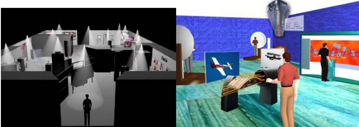
Εικόνα 3.4 Όταν ο επισκέπτης της έκθεσης, φορώντας το σύστημα επαυξημένης πραγματικότητας, βρεθεί σε έναν προκαθορισμένο χώρο μπροστά από το κάθε έκθεμα (φωτισμένες κωνικές περιοχές στην εικόνα αριστερά), επιπρόσθετη πληροφορία (εικόνα, βίντεο, προσομοίωση, κείμενο) παρουσιάζεται στο οπτικό του πεδίο (εικόνα δεξιά). Στο πλαίσιο της εργασίας, αυτή η πληροφορία που γίνεται διαθέσιμη αφορά σε εκπαιδευτικό υλικό που είχε προετοιμαστεί από τους εκπαιδευτικούς και τους παιδαγωγούς του μουσείου που συμμετείχαν στο σχεδιασμό των εκπαιδευτικών δραστηριοτήτων.
