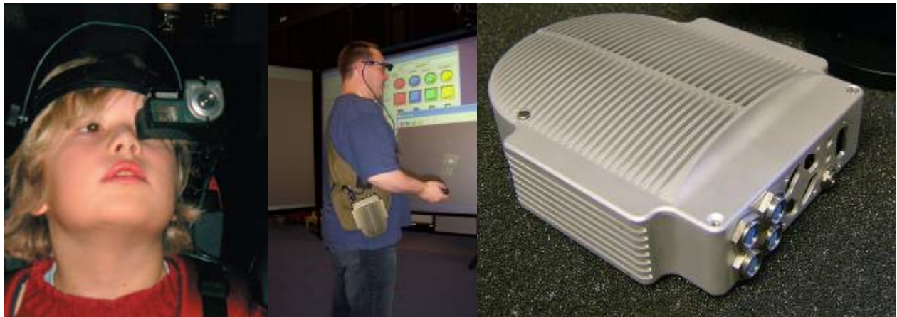
Εικόνα 3.5 Το σύστημα επαυξημένης πραγματικότητας φοριέται από το χρήστη και περιλαμβάνει ένα προηγμένο οπτικό σύστημα και ένα σύστημα προσδιορισμού θέσης και προσανατολισμού (αριστερά) που ελέγχονται από έναν μικρό επεξεργαστή (δεξιά) που προσαρτάται στη ζώνη του επισκέπτη (κέντρο).
