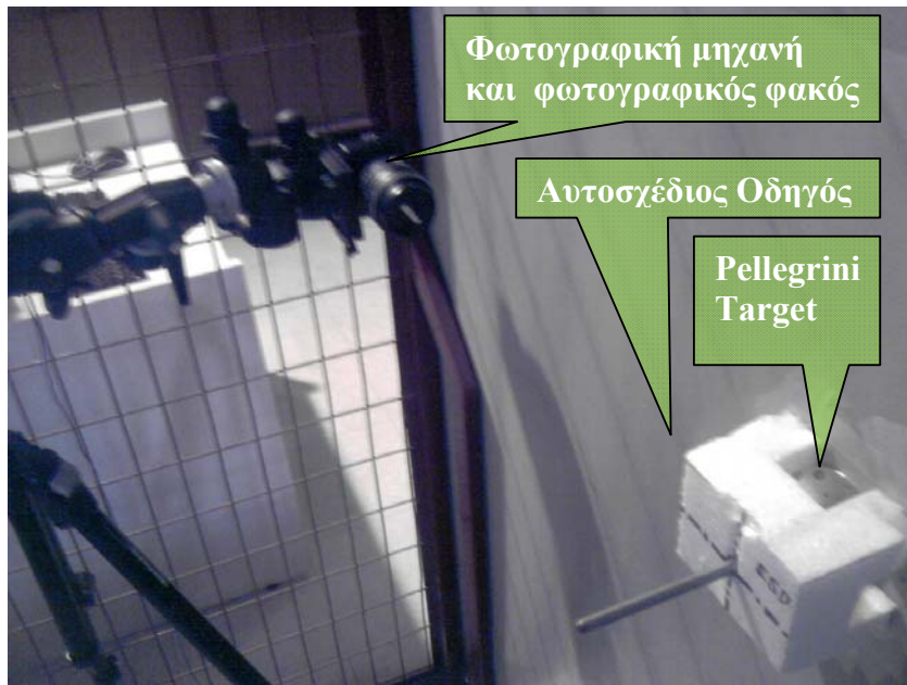
Σχήμα 3.29: Πειραματική διάταξη καταγραφής του τόξου εκφόρτισης, με τη βοήθεια ψηφιακής φωτογραφικής μηχανής μεγάλης ευαισθησίας
