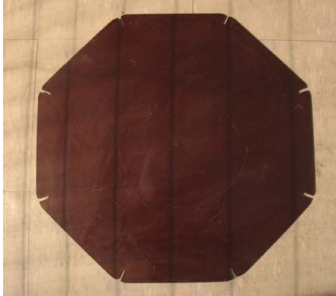
Σχήμα 3.19: Επιδαπέδιο μονωτικό (βακελίτης)
