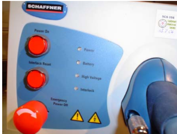
Σχήμα 3.4: Η βασική μονάδα της γεννήτριας με τα κομβία χειρισμού και τις ενδεικτικές λυχνίες
