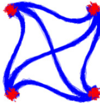
Σχήμα 4.10: Διάγραμμα αστερισμού DQPSK σήματος κατά τη διάρκεια μετάδοσης σε μέσο διασποράς. Η μορφή Cornu-spiral προκαλεί διασυμβολική παρεμβολή με αποτέλεσμα την υποβάθμιση της ποιότητας του σήματος.
