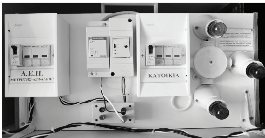
Σχήμα 2.15: Διάταξη προστασίας μέσω επιτηρητή τάσης
