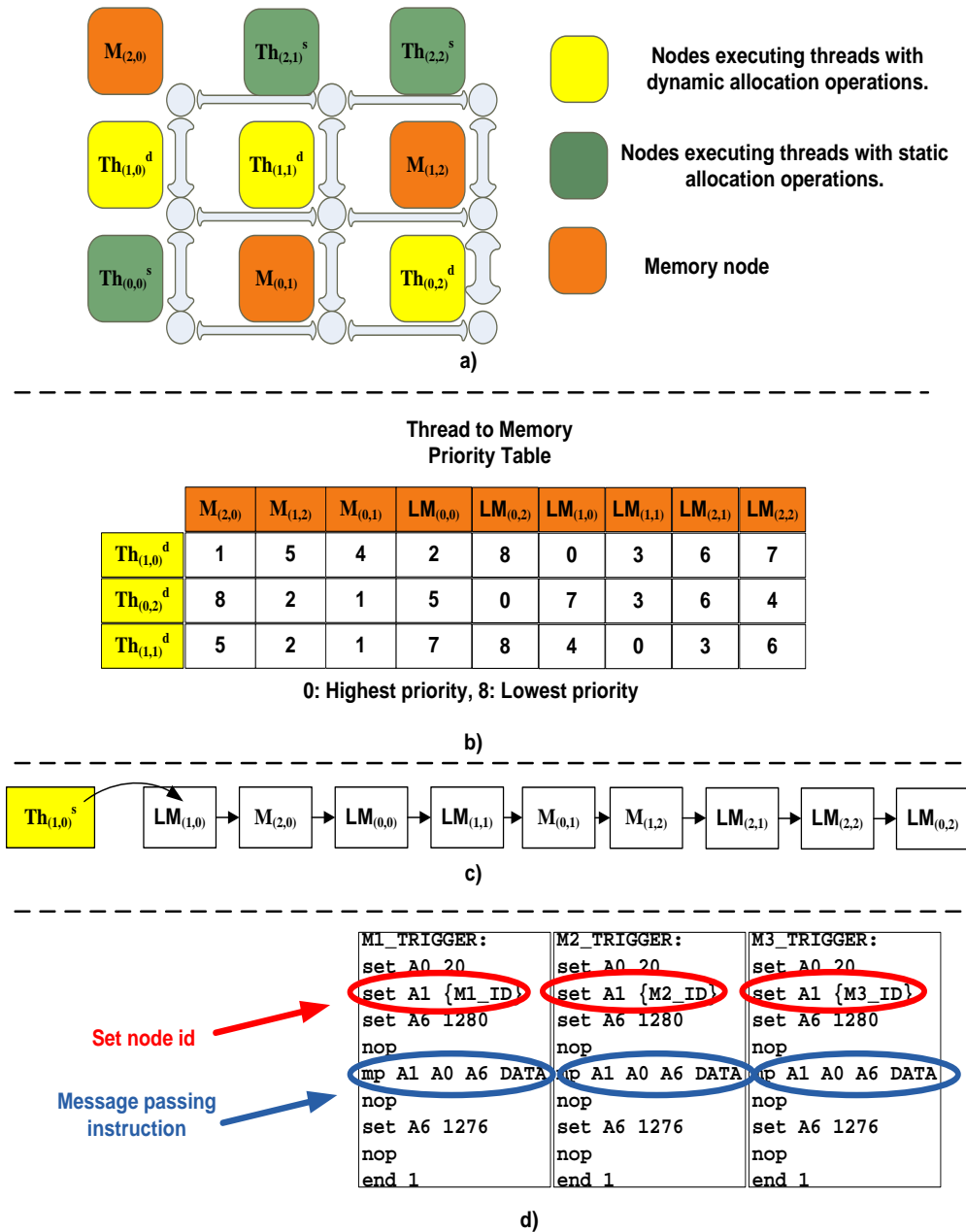
Σχήμα 3.7: Παράδειγμα προσαρμογής ΔΔΜ με βάση την κατανομή της μνήμης σε πολυπύρηνη αρχιτεκτονική: a) Τοπολογία και απεικόνιση πυρήνων, b) Πίνακας προτεραιοτήτων, c) Δομή απλά συνδεδεμένης λίστας, d) Πρότυπα συναρτήσεων επικοινωνίας σε μικροκώδικα.
